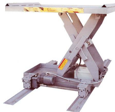
Slika 2.7: Transportno postolje sa motorom pogonjenim kotačima
