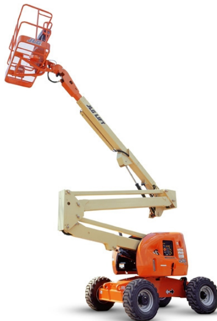
Slika 1.4: Radna platforma sa više spojenih zglobnih paralelograma
