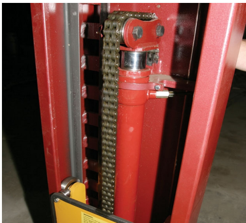
Slika 1.5: Hidraulički cilindar i prijenos lančanicima
