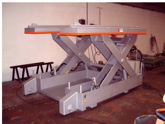
Slika 2.48: Podizna platforma za ugradnju kotača na željeznička vozila
