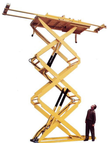
Slika 2.51: Podizna platforma prilagođena za balansiranje helikopterskih elisa
