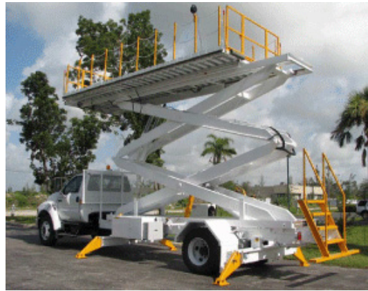
Slika 2.54: Kamionska radna platforma nosivosti 1000kg za inspekciju i održavanje aviona
