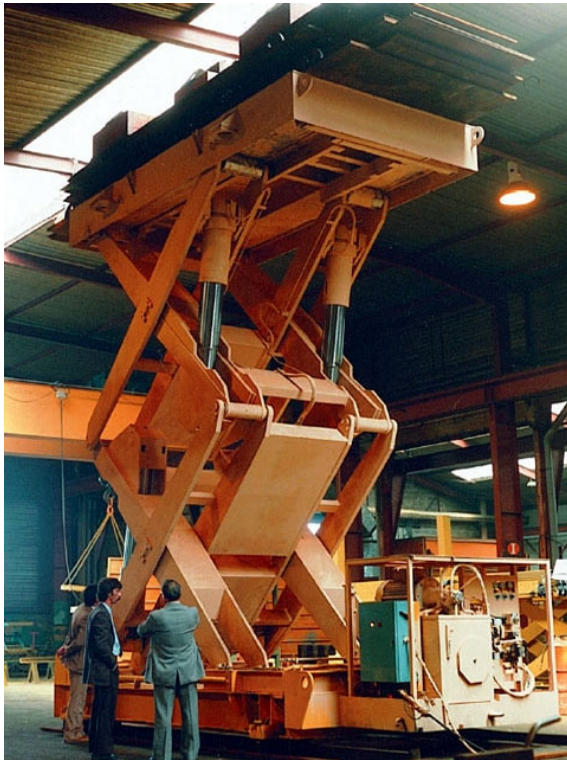
Slika 2.45: Podizna platforma za montažu/demontažu turbina u hidroelektrani
