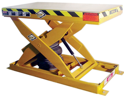
Slika 2.24: Pneumatski pogon s jednim zračnim jastukom
