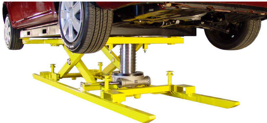
Slika 2.29: Radionička podizna platforma sa škarastim mehanizmom i pogonom pomoću mehanizma sa spiralnim stupom
