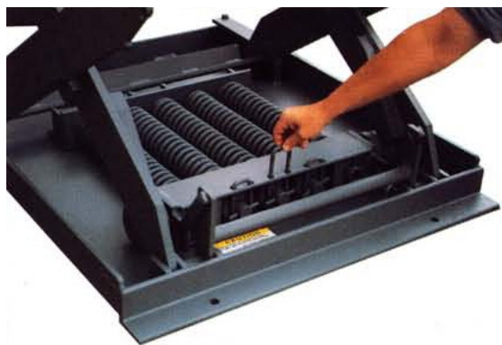
Slika 2.38: Podešavanje potrebne nosivosti vađenjem ili umetanjem U-zatika
