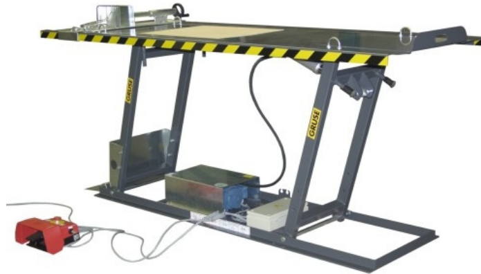
Slika 1.3: Radionička podizna platforma sa zglobnim paralelogramom za popravak motocikala
