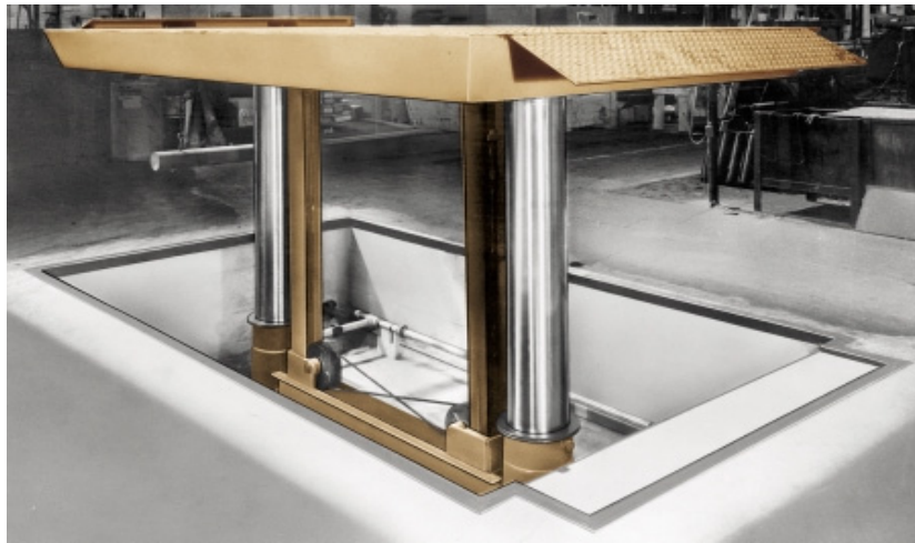
Slika 1.7: Hidraulički cilindar zatvoren u klizno kućište
