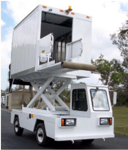
Slika 2.53: Kamionska podizna platforma nosivosti 550kg za utovar/istovar aviona
