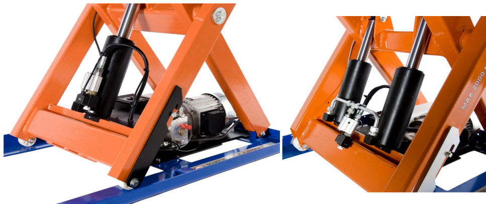
Slika 2.23: Elektrohidraulički pogon s jednim i dva cilindra
