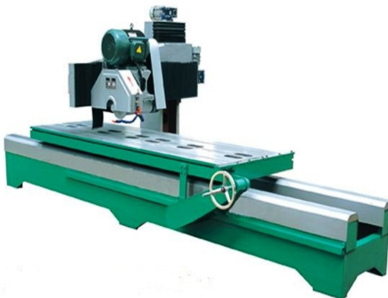
Slika 8. Konzolni stroj za rezanje kamena [3]
