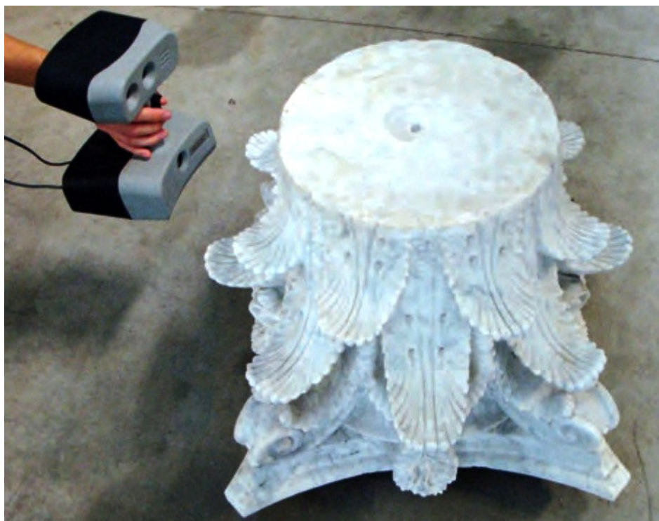
Slika 23. Skeniranje kapitela kamenog stupa [4]
