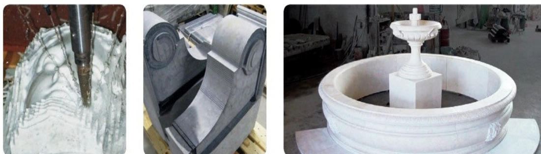
Slika 18. Primjeri kamenih obradaka sa višeosnog obradnog centra za glodanje kamena
