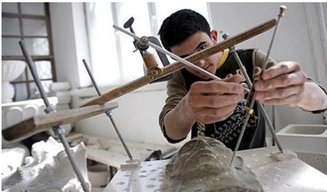
Slika 20. Naprava za ručno kopiranje- puntirka
