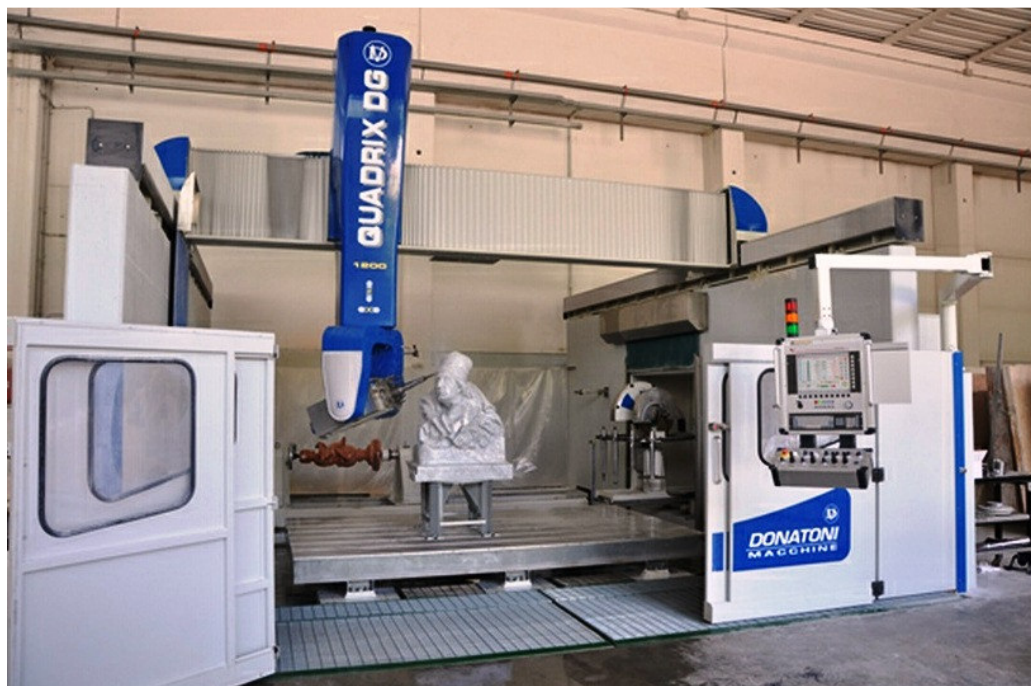
Slika 17. Višeosni obradni centar za glodanje kamena [4]
