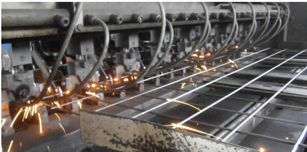
Slika 1.7. Proizvodnja armaturene mreže u pogonu tvrtke ARMKO.
