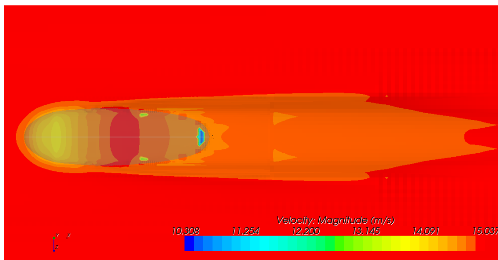
Slika 26: Polje brzine na slobodnoj površini - pogled odozgo
