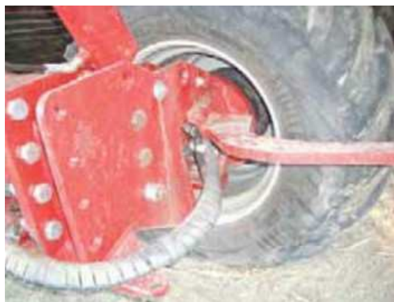
Slika 17 Hidraulički sustav za zakretanje kotača
