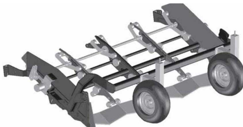
Slika 14 Sklop prednjeg noža sa dodatnim kotačima
