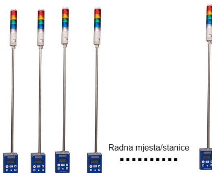
Slika 11. Primjer ANDON bljeskalice [10]
