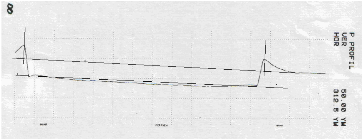
Slika 42. Topograf kratera prevlake Ni – P nakon 360 [s] trajanja ionskog odnošenja
