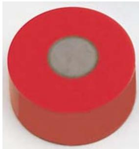
Slika 13. Uzorak spreman za mehaničku obradu [9]
