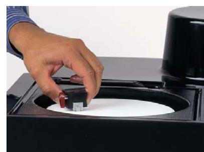
Slika 15. Uređaj za ručno brušenje i poliranje [9]
