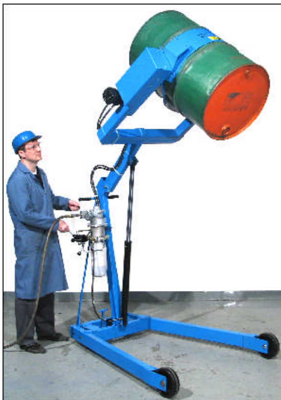
Slika 13. Hidraulični podizni izljevač-nosač
