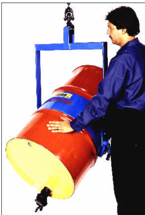
Slika 36. Dodatak kuki: nosač za izlivanje s ručnim okretanjem bačve
