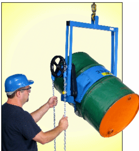
Slika 34. Dodatak kuki: nosač za izlijevanje s okretanjem bačve pomoću lanca
