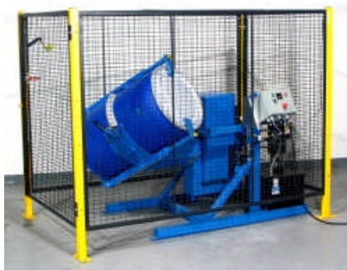
Slika 7. Zaštitna ograda za prevrtač bačvi pod nagibom
