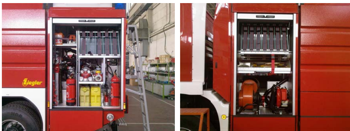
Slika 5: Smještaj spremnika cijevi na stvarnom vozilu u pogonu tvrtke Ziegler
