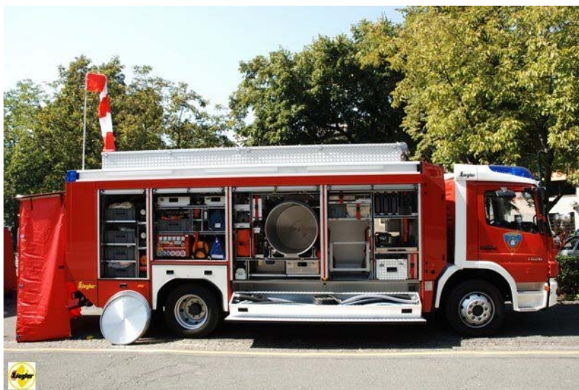
Slika 1: Izgled unutrašnjosti vozila za kemijske akcidente gledano s boka
