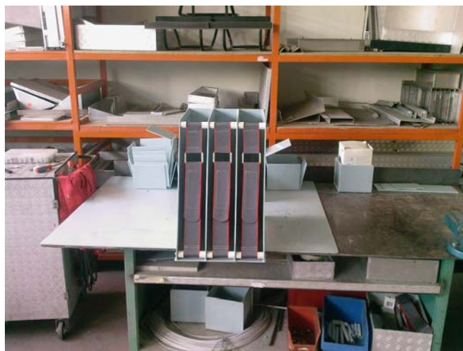
Slika 3: Prikaz spremnika cijevi za gašenje požara prije montaže u vozilo
