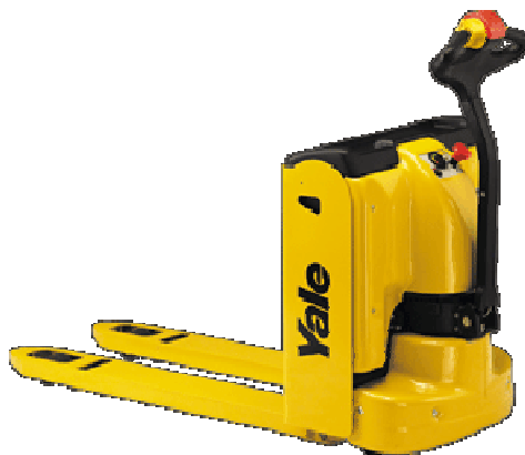
Slika 6. Paletni niskopodizni viličar
