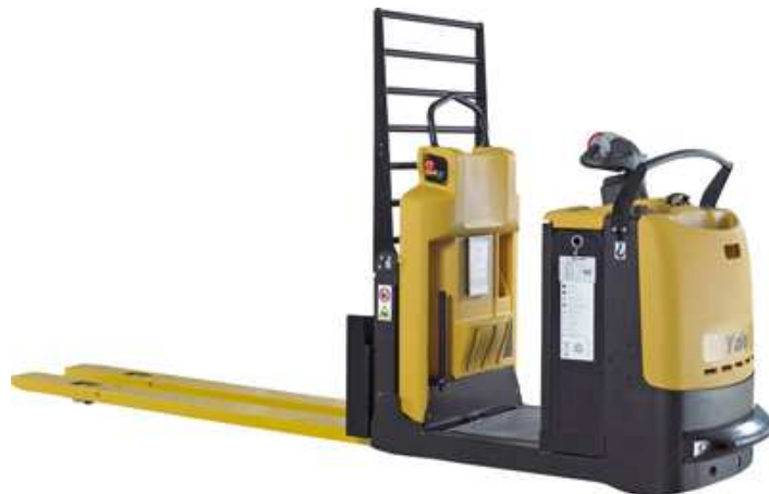
Slika 7. Horizontalni viličar za komisioniranje
