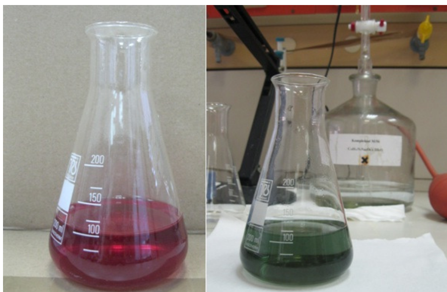
Slika 17. Promjena boje mjerenjem ukupne tvrdoće
