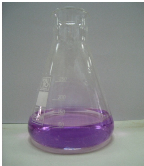
Slika 15. Promjena boje kod određivanja „p“- alkaliteta
