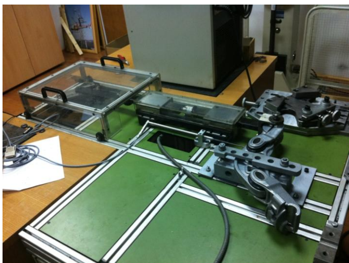
(Slika 1.15.) Uređaj za ispitivanje konstante krutosti i konstante prigušenja rastojnika prigušivača
