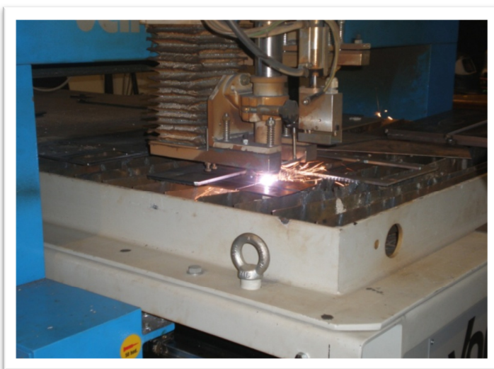
Slika 18. Rezanje ispitnih uzoraka na Vanad-u 2000
