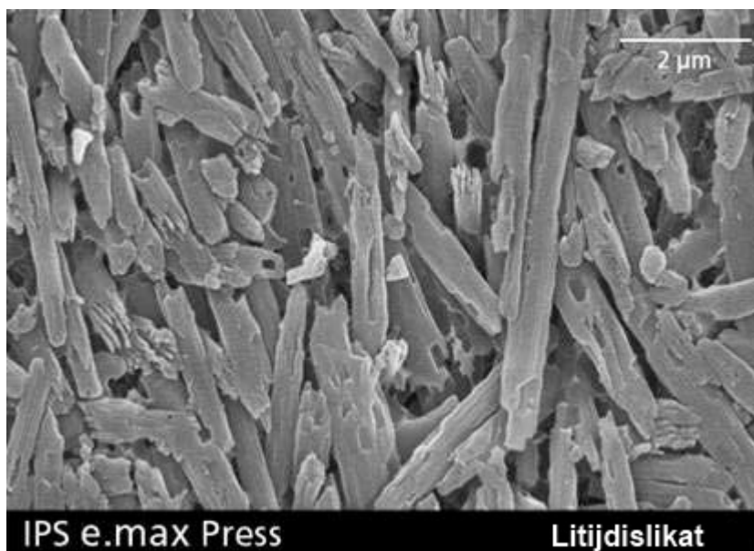
Slika 28. Mikrostruktura IPS e.max Press
