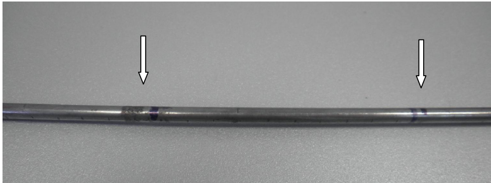
Slika Pogreška! Za dodavanje Heading 1 tekstu koji želite da se ovdje pojavi koristite karticu Početno..4. Prandt I-Pitotova cijev sa oznakama
