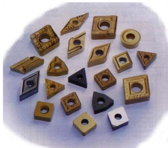
Slika 2.3.2.4. Različite vrste reznih pločica, različite geometrije, broja oštrica i materijala [1].
