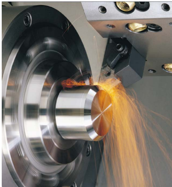
Slika 3.2.1. Generiranje visokih temperatura pri tvrdom tokarenju [13].
