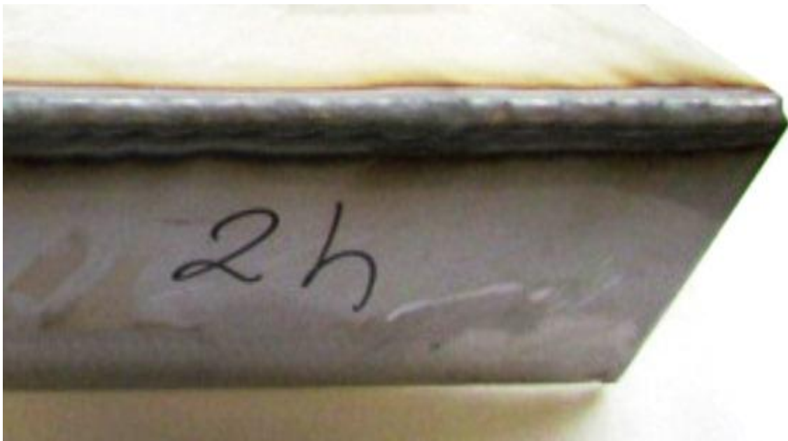
Slika 20. Uzorci zavarivanja rubnog spoja 2g i 2h, kontinuiranim i impulsnim strujama pod zaštitnom atmosferom mješavine argona i 5% vodika
