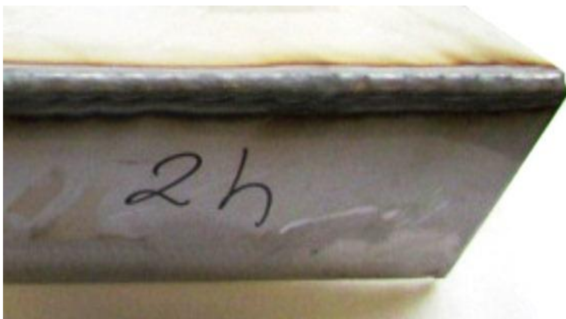
Slika 20. Uzorci zavarivanja rubnog spoja 2g i 2h, kontinuiranim i impulsnim strujama pod zaštitnom atmosferom mješavine argona i 5% vodika
