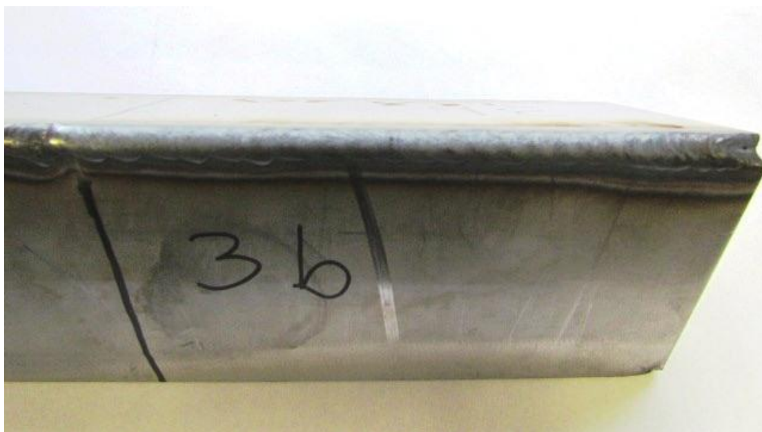
Slika 25. Uzorci zavarivanja rubnog spoja 3a i 3b, kontinuiranim i impulsnim strujama pod zaštitnom atmosferom argona
