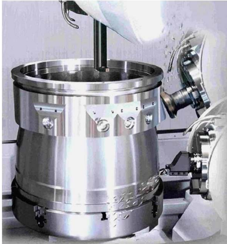
Slika 5.4. Primjer obrade tokarenja na glodaćem okretnom stolu [15]
