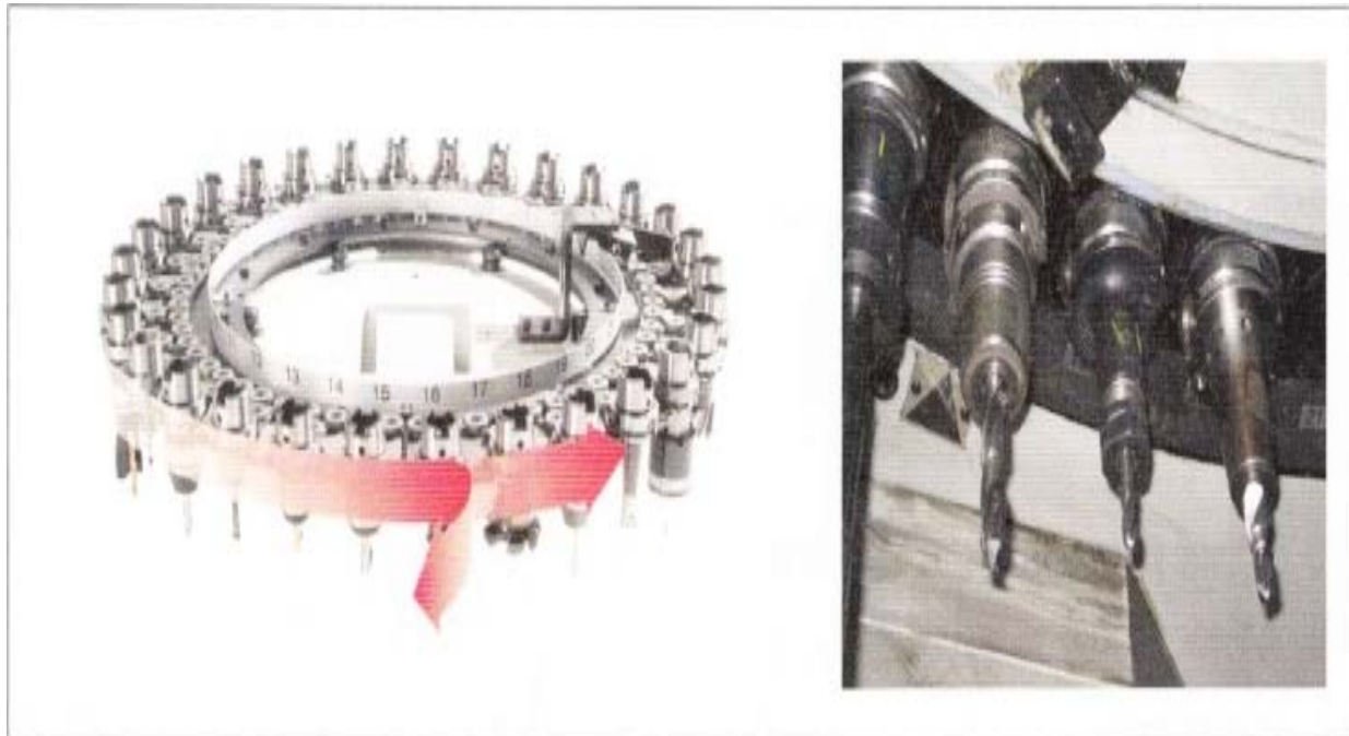
Slika 3.16. Kružno spremište alata [12]
