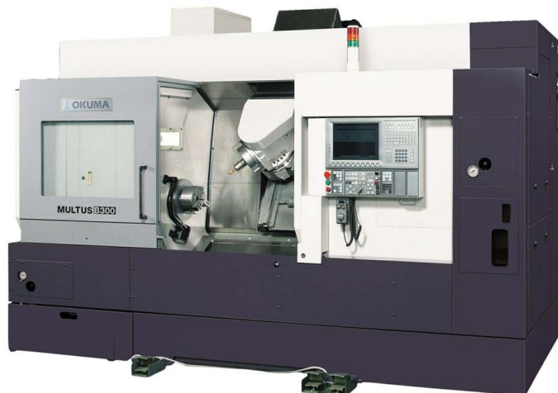
Slika 5.2. Višenamjenski alatni stroj MULTUS B300 , [9 OKUMA] [13]
