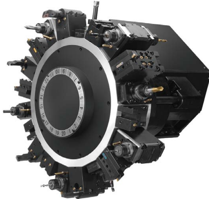
Slika 4.11. Revolverska glava sa 20 alata [10]
