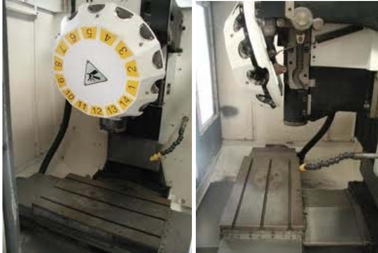
Slika 3.19. Direktna izmjena alata bez poluge [STAMA MC 014] [8]
