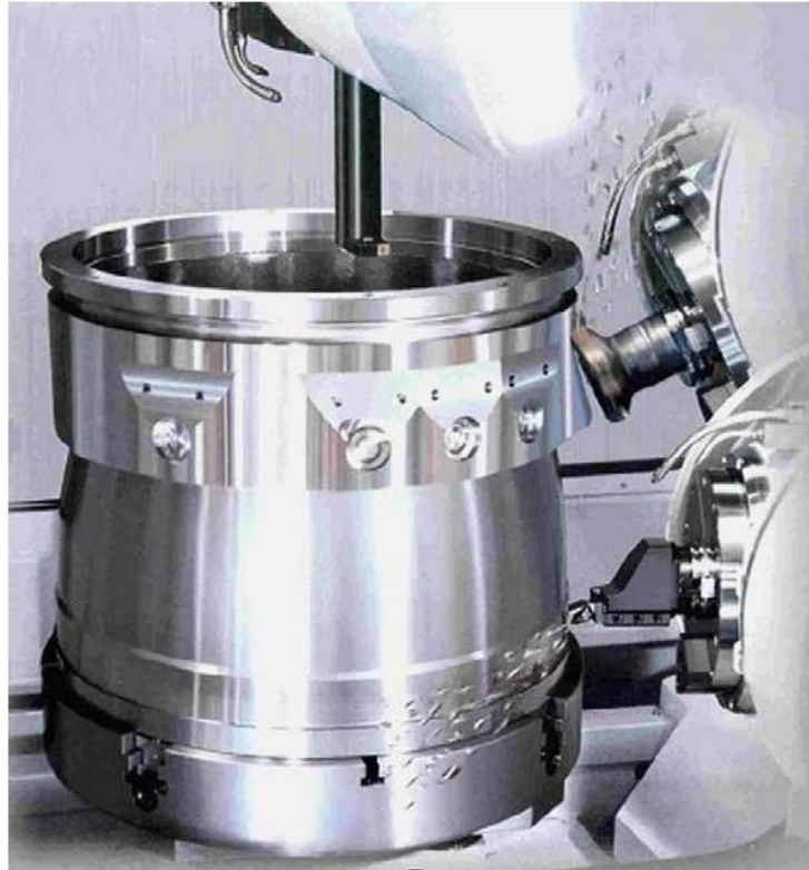
Slika 5.4. Primjer obrade tokarenja na glodaćem okretnom stolu [15]
