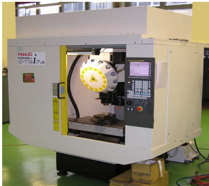
Slika 3.1. Numerički upravljana glodalica [8]
