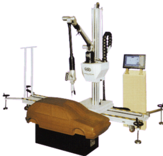
Slika 4.4 Kontaktni optički mjerni uređaj [7]
