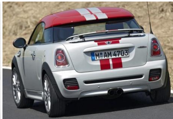
Slika 57: Stražnji kraj Mini Coupe-a. Vidi se aktivni stražnji spojler koji rješava problem potlaka na stražnjem staklu
