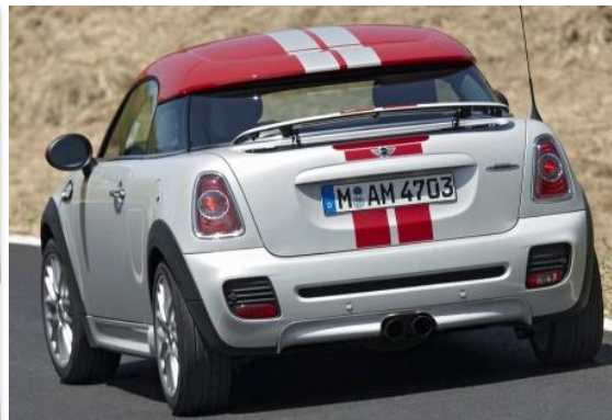
Slika 57: Stražnji kraj Mini Coupe-a. Vidi se aktivni stražnji spojler koji rješava problem potlaka na stražnjem staklu
