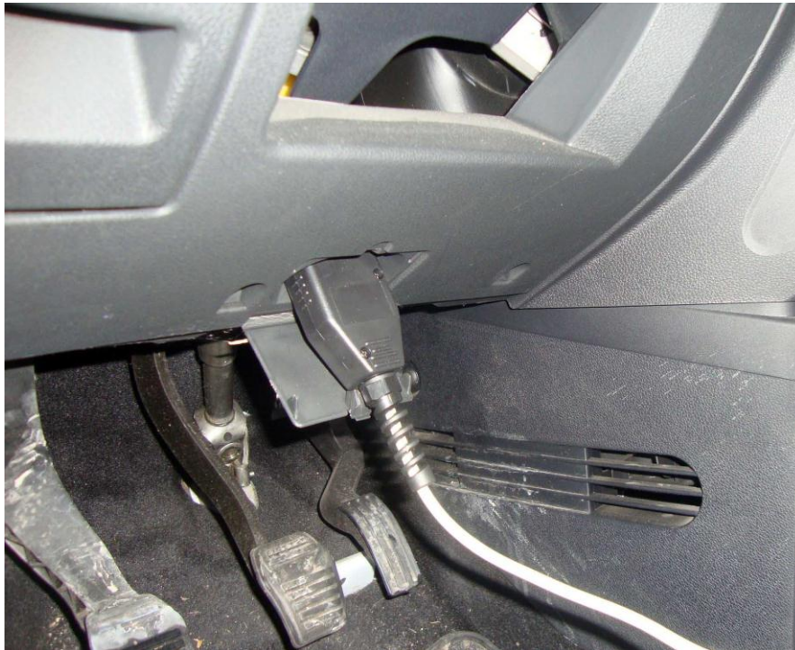
Slika 5.22. Lokacija dijagnostičkog priključka na vozilu Ford Fusion.
