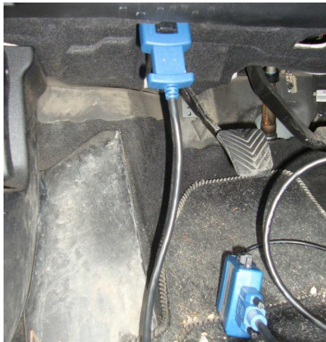
Slika 5.12. Lokacija dijagnostičkog priključka na vozilu Kia Cee'd.
