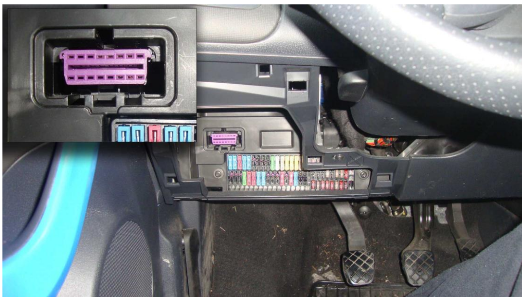
Slika 5.17. Lokacija dijagnostičkog priključka na vozilu Seat Ibiza.
