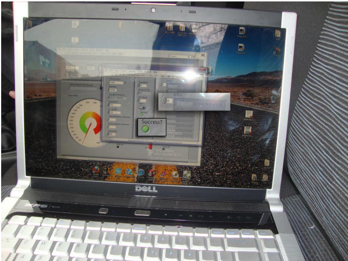
Slika 5.14. Programsko sučelje za očitavanje DTC-ova na vozilu Kia Cee'd.
