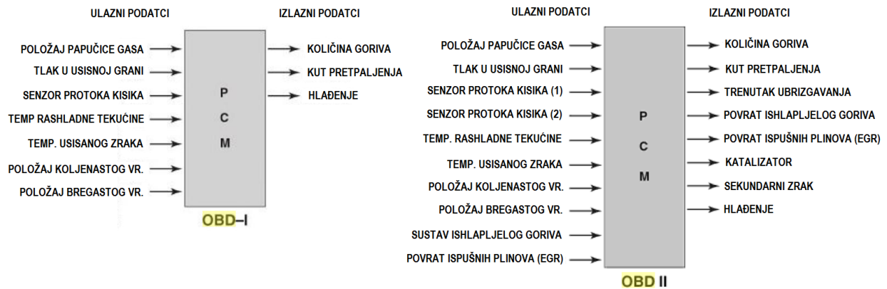
Slika 2.3. Usporedba nadziranih podsustava OBD-I i OBD-II sustava.
