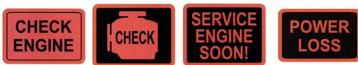
Slika 2.1. Mogući izgledi OBD-I kontrolne žaruljice, MIL [1].
