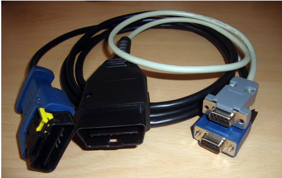
Slika 5.4. EOBD – DB9 kabeu korišteni za spajanje uređaja NI USB-8473s i vozila. Razlika je u EOBD konektorima, plavi ima plastiku za osiguranje protiv ispadanja.
