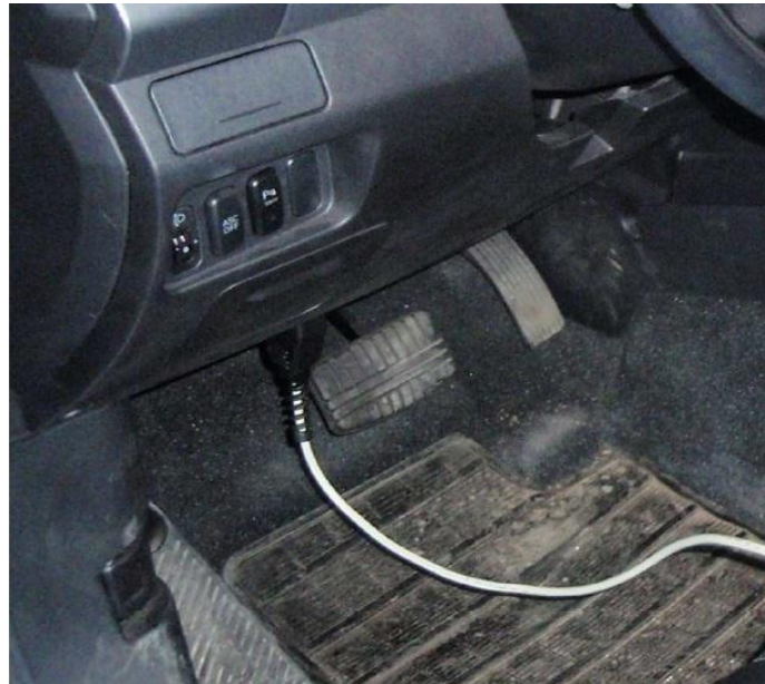
Slika 5.15. Lokacija dijagnostičkog priključka na vozilu Citroen C-Crosser.
