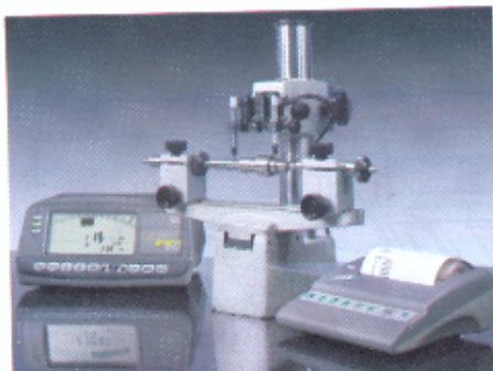
Slika 4.18. Provjera osnosti čepova vratila induktivnim mjerilom
