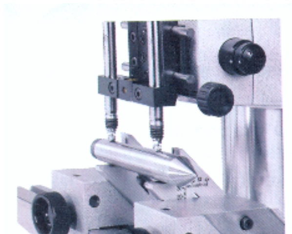
Slika 4.20. Provjera kružnosti konusa šiljka konjića induktivnim uređajem
