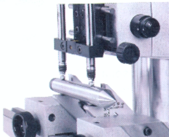
Slika 4.20. Provjera kružnosti konusa šiljka konjića induktivnim uređajem
