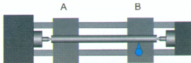
Slika 4.26. Provjera točnosti pomicanja suporta tokarilice po uzdužnoj osi
