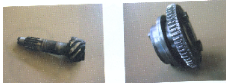
a) Savijeno vratilo i oštećeni zubi zupčanika, b) oštećenje zuba zupčanika na zupčaniku spojke
