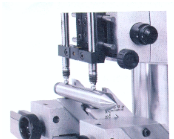
Slika 4.20. Provjera kružnosti konusa šiljka konjića induktivnim uređajem
