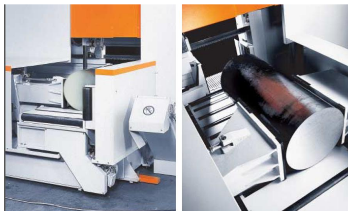
Slika 42. Hidraulički škripac sa automatiziranim dostavnim gibanjem [22]
