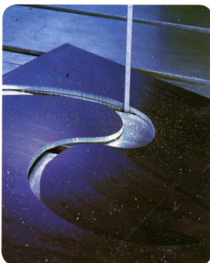
Slika 34. Izrada složene konture na vertikalnoj tračnoj pili [18]
