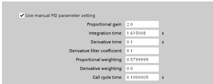
Slika 37: Parametri PID regulatora
