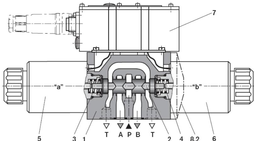
Slika 4: Presjek proporcionalnog ventila
