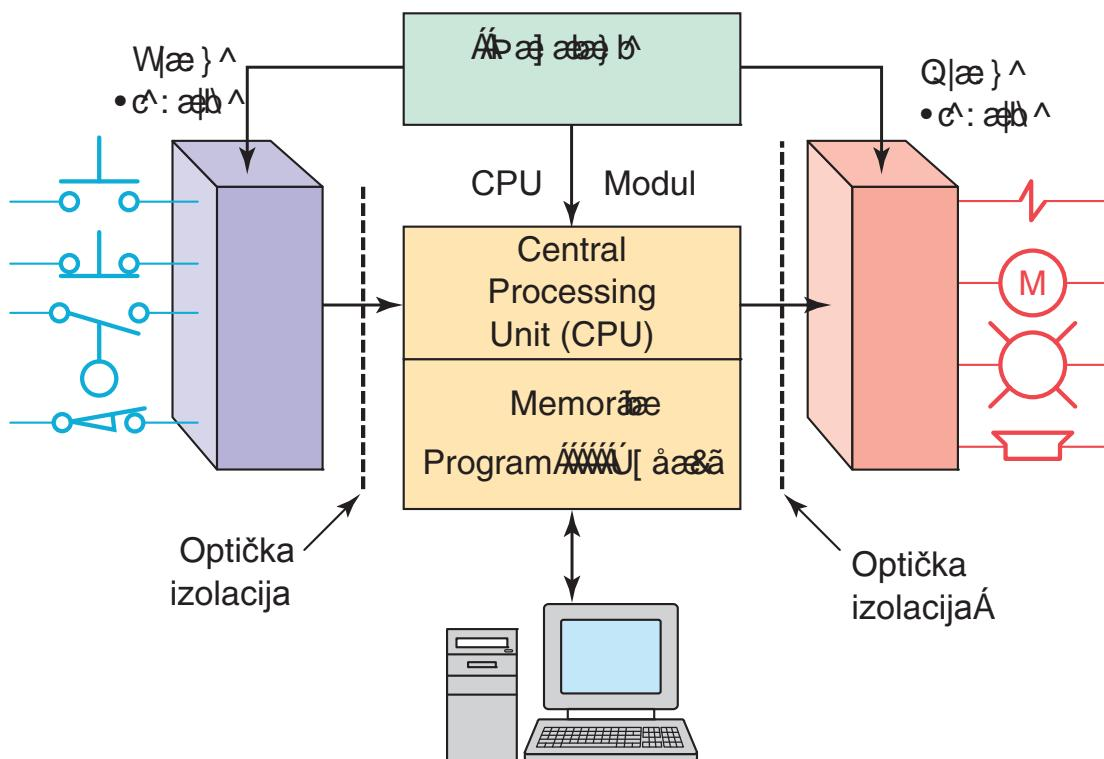
Slika 9: Ulagano/izlazni sklopovi (I/O)
