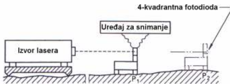
Slika 18: Metoda kolimacionog lasera
