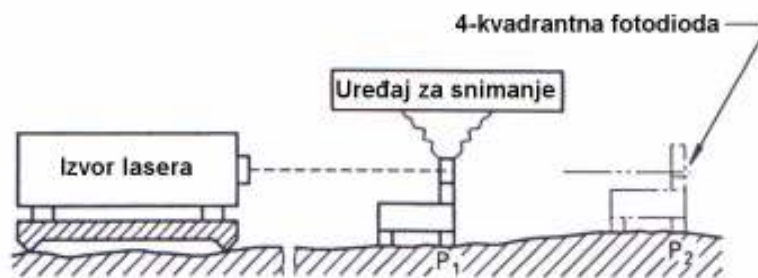
Slika 18: Metoda kolimacionog lasera
