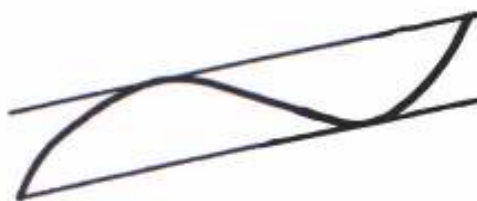
Slika 10: Pravocrtnost linije na plohi
