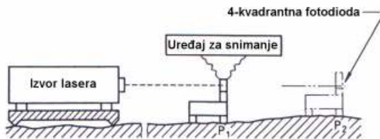
Slika 18: Metoda kolimacionog lasera
