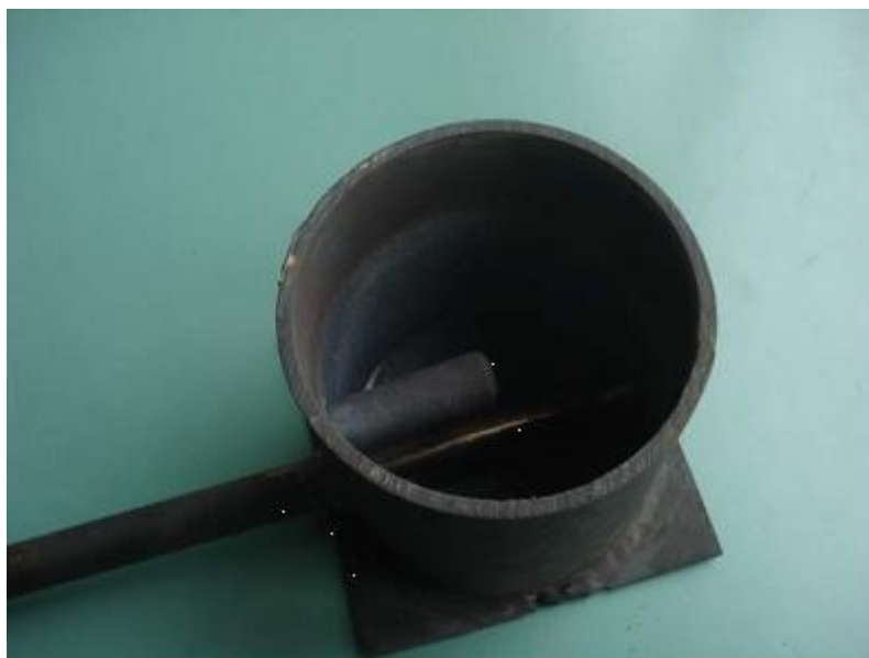
Slika 42. Retorta za provođenje postupka aluminiziranja
