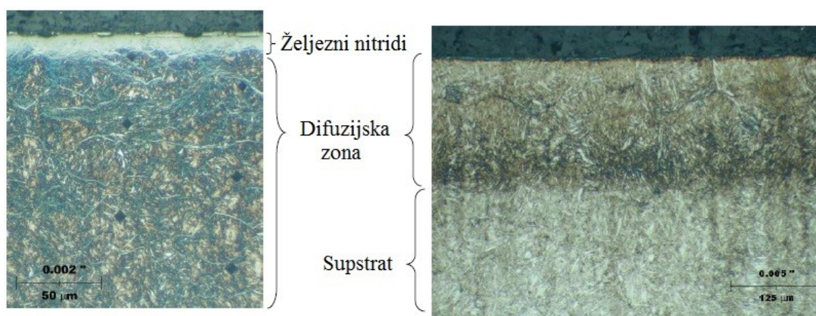
Slika 12. Mikrostruktura legure za nitiranje komercijalnog naziva Nitralloy 135M nakon kaljenja i popuštanja te plinskog nitiranja [3]
