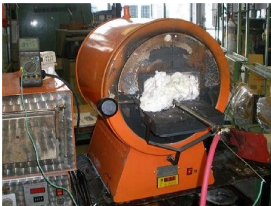
Slika 43. Peć s retortom za aluminiziranje
