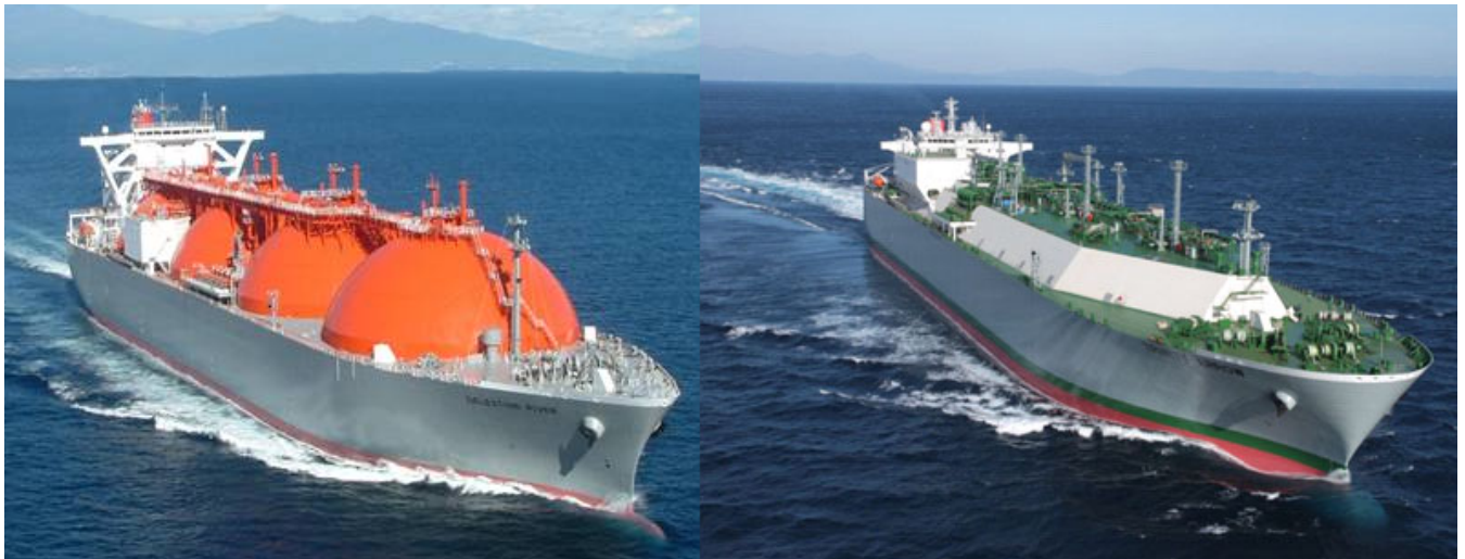
Slika 10: Vizualna usporedba LNG tankera sa sfernim i membranskim tankovima
