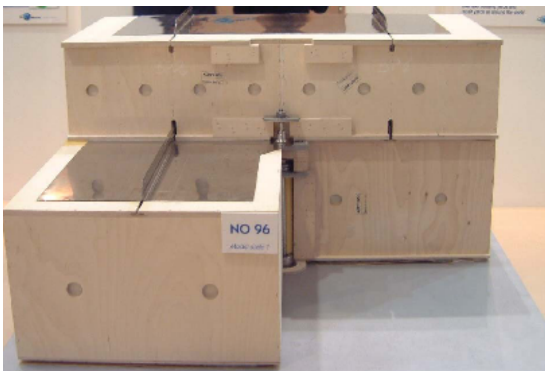
Slika 26: Izolacijska kutija-Gaztransport No 96
