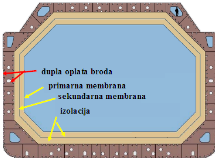
Slika 19: Poprečni presjek membranskog tanka
