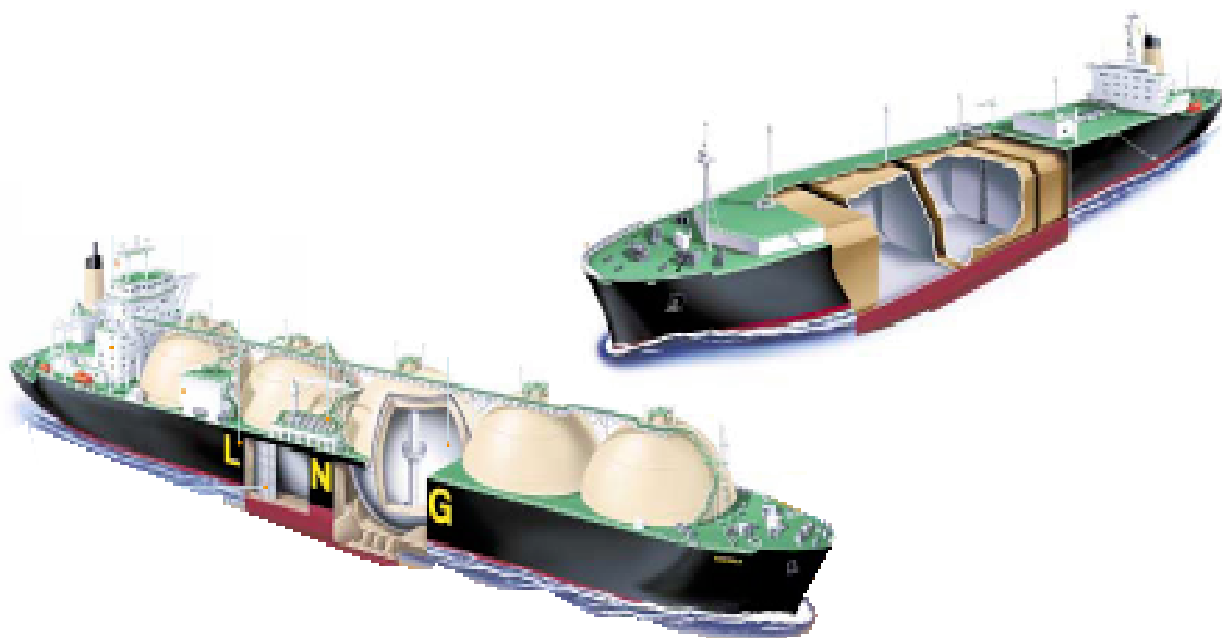
Slika 11: Prikaz LNG tankova unutar broda sa sfernim, odnosno membranskim spremnicima
