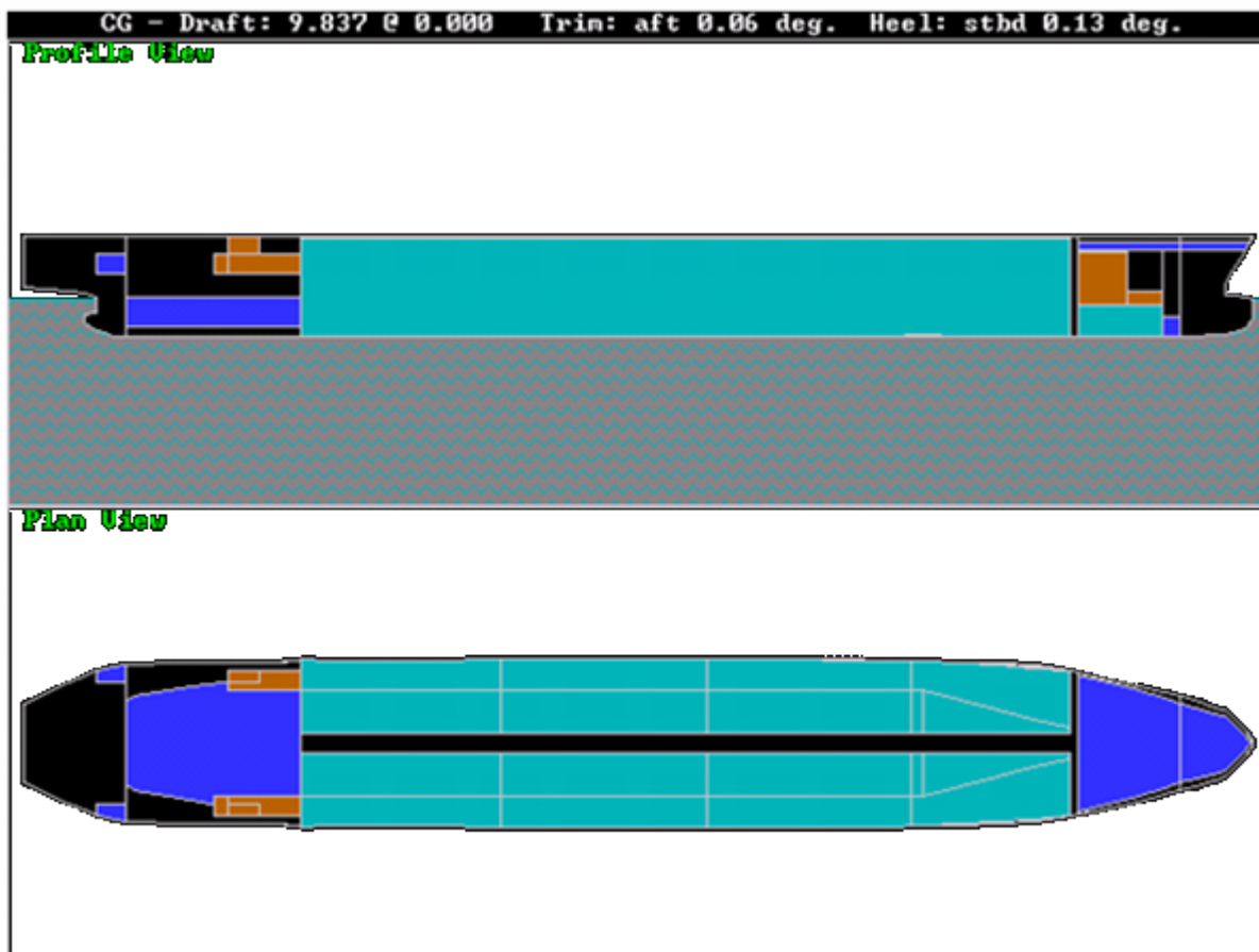
Slika 49: Prikaz broda u programu GHS, popunjenost tankova karakteristična za treće stanje krcanja
