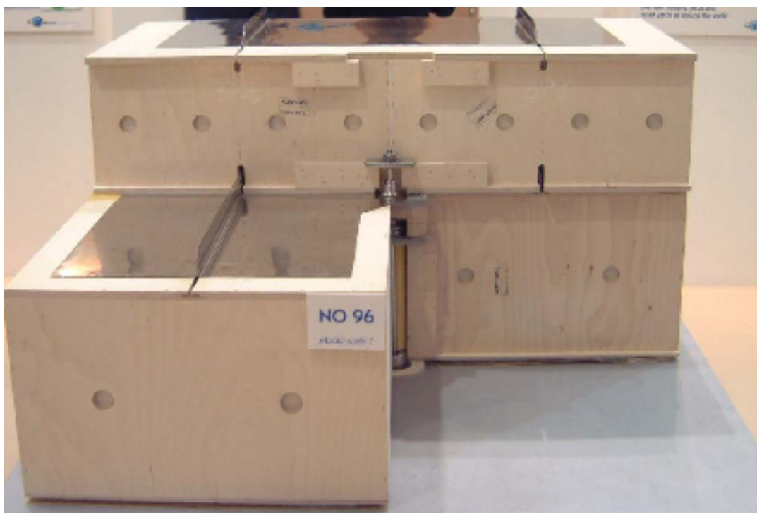
Slika 26: Izolacijska kutija-Gaztransport No 96
