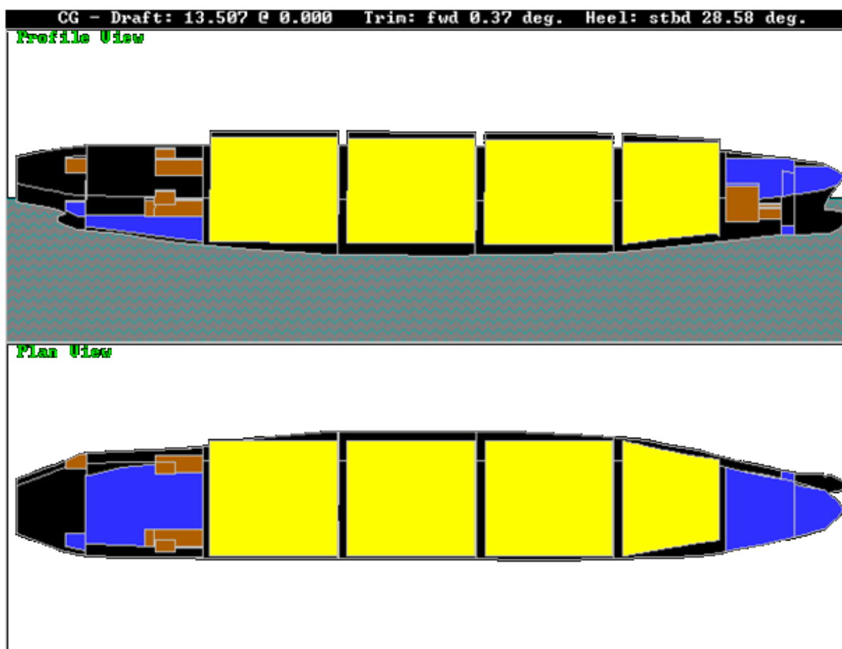
Slika 62: Prikaz broda u programu GHS, popunjenost tankova karakteristična za 1.stanje krcanja
