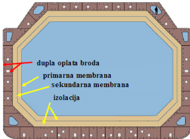
Slika 19: Poprečni presjek membranskog tanka
