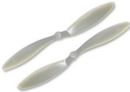
Slika 3.3: Par suprotno rotirajućih propelera APC Slow Flyer 10 × 4.7
