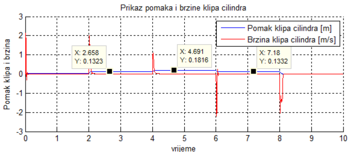
Slika 55 Odziv pomaka i brzine klipa cilindra
