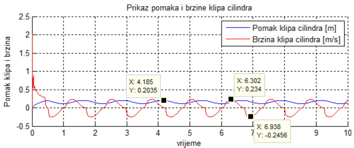
Slika 59 Odzivi pomaka i brzine klipa cilindra
