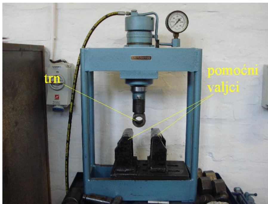
Slika 71. Naprava za ispitivanje zavarenih spojeva na savijanje
