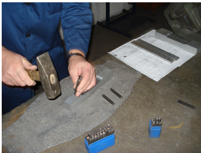
Slika 60. Označavanje epruveta za statički vlačni pokus
