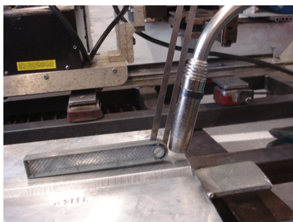
Slika 29. Namještanje pištolja za zavarivanje
