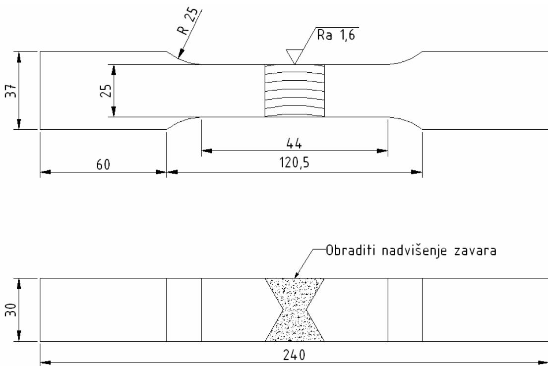
Slika 42. Skica epruvete za statički vlačni pokus
