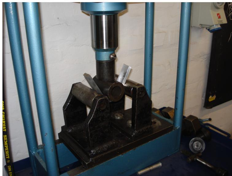
Slika 72. Savijanje epruvete na napravi za savijanje
