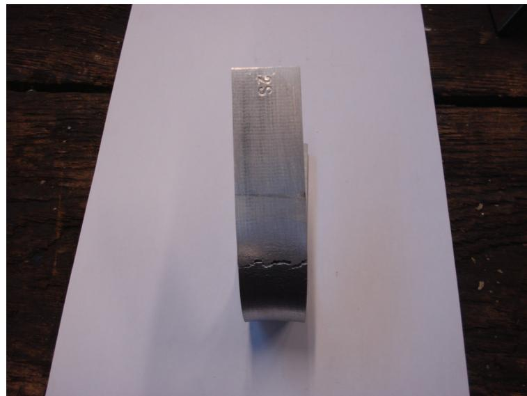
**Slika 75. Pucanje osnovnog materijala tokom ispitivanja ( epruveta 2S )**
