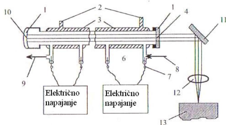
Slika 21. Shematski prikaz CO<sub>2</sub> lasera [2]
