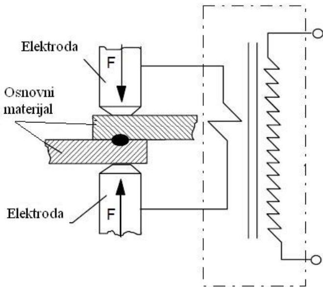
Slika 22. Shematski prikaz elektrootpornog točkastog zavarivanja [11]
