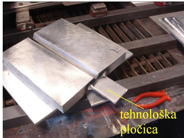
Slika 25. Prijevod tehnološke pločice
