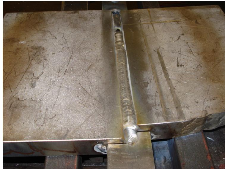
**Slika 39. Korijenski zavar izveden TIP-TIG postupkom**
