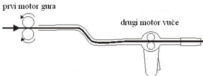
Slika 8. Shematski prikaz „push-pull“ sustava za dodavanje žice [10]
