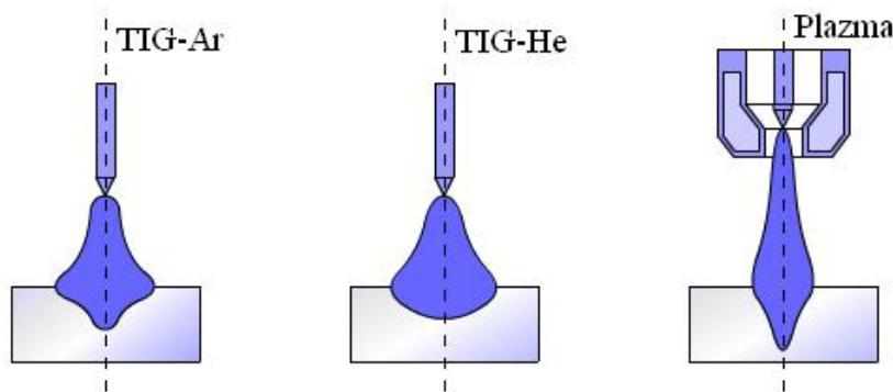
**Slika 19. Usporedba električnog luka pri TIG zavarivanju i plazma zavarivanju [14]**
