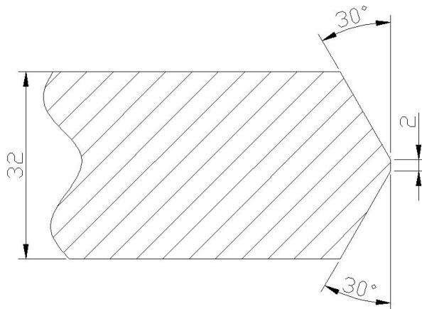
**Slika 23. Priprema rubova za zavarivanje na ploči aluminijске legure AlMg4,5Mn**
