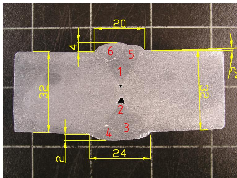
Slika 47. Uzorak za makroskopsku analizu dobiven TIP-TIG postupkom
