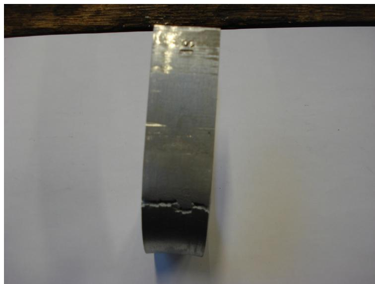
Slika 73. Pucanje osnovnog materijala tokom ispitivanja (epruveta 1S)
