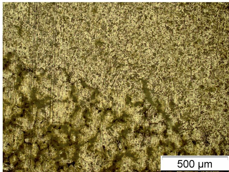
Slika 52. Zona staljivanja na uzorku zavarenom MIG postupkom
