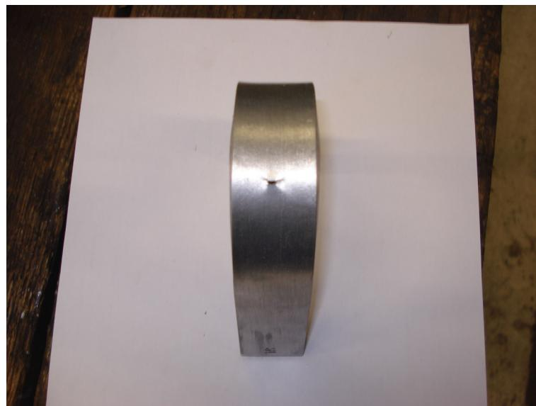
**Slika 74. Pucanje zavara u zavarenom spoju ( epruveta 1S )**
