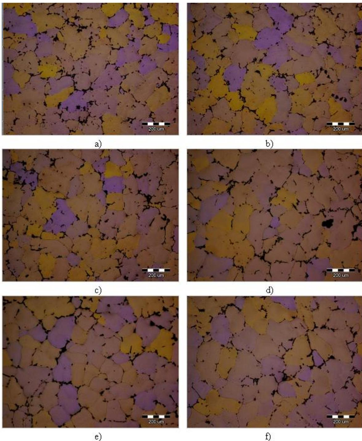
**Slika 59.** Snimke mikrostrukture osnovnog materijala aluminijске legure EN AW 5083 u lijevanom stanju, nagrijeno elektrolitički Barker-ovim reagensom, promatrano svjetlosnim mikroskopom ( polarizacijsko svjetlo i tintni filter )
