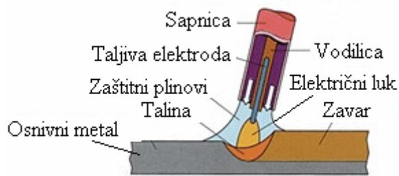
**Slika 6. Shematski prikaz procesa zavarivanja MIG postupkom [12]**
