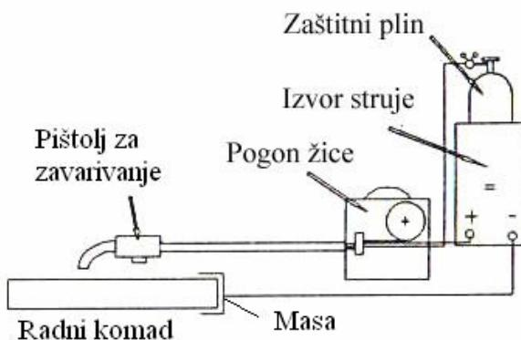
Slika 5. Shematski prikaz uređaja za MIG zavarivanje [11]
