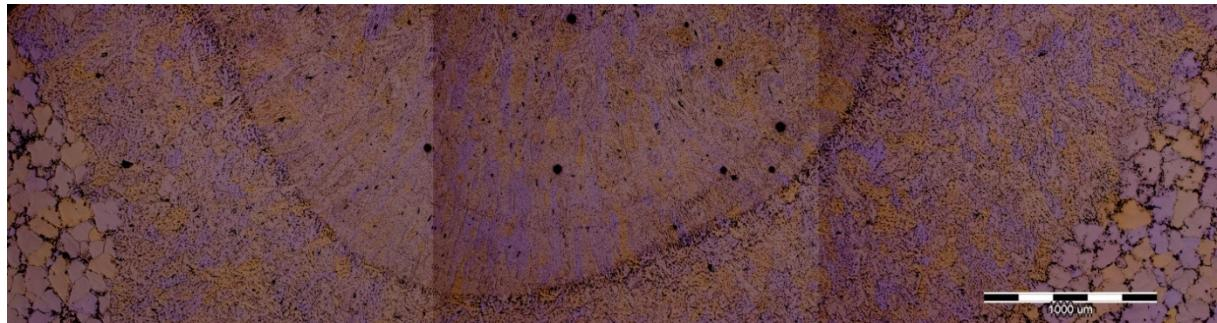
**Slika 57. Snimka mikrostrukture korijena zavara izvedenog MIG postupkom aluminijске legure EN AW 5083 u lijevanom stanju ( mjesta ispitivanja 2a-1, 2a-2, 2a-3 )**
