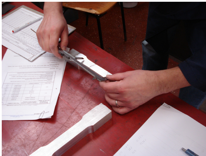
Slika 64. Mjerenje konačne duljine između dvije mjerne točke ( nakon kidanja )
