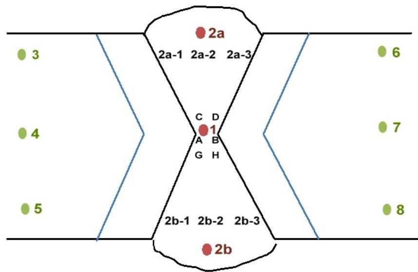
Slika 53. Shema uzimanja uzorka za mikroskopsku analizu
