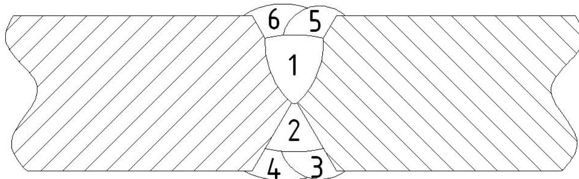
Slika 38. Redoslijed zavarivanja TIP-TIG postupkom
