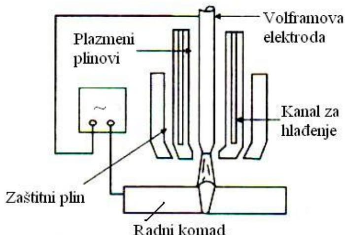
**Slika 18. Shematski prikaz plazma postupka zavarivanja [2]**
