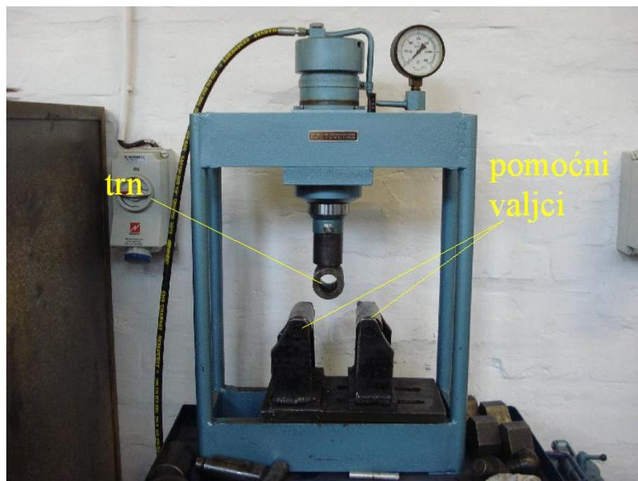
**Slika 71. Naprava za ispitivanje zavarenih spojeva na savijanje**
