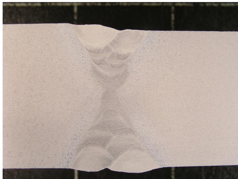
**Slika 44.** Uzorak za metalografsko ispitivanje dobiven MIG zavarivanjem
