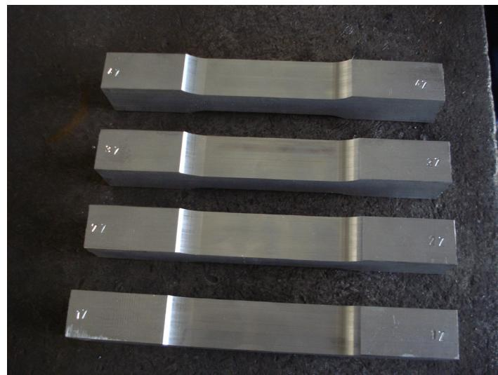
Slika 61. Označene epruvete za statičko vlačni pokus
