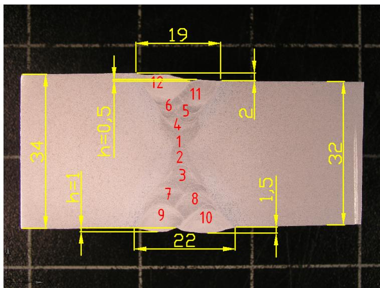
**Slika 46. Uzorak za makroskopsku analizu dobiven MIG postupkom zavarivanja**
