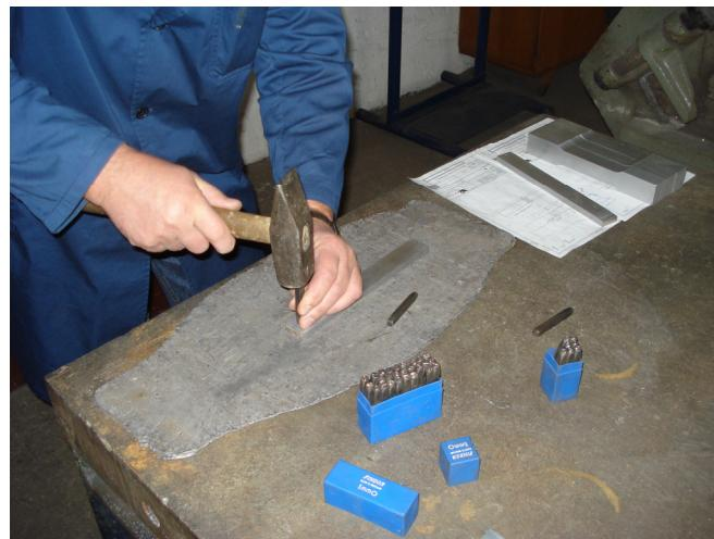
Slika 69. Označavanje epruveta za ispitivanje savijanjem
