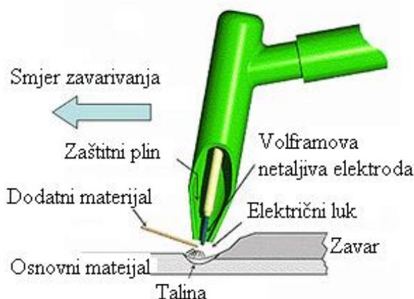
Slika 14. Shematski prikaz TIG postupka zavarivanja [12]
