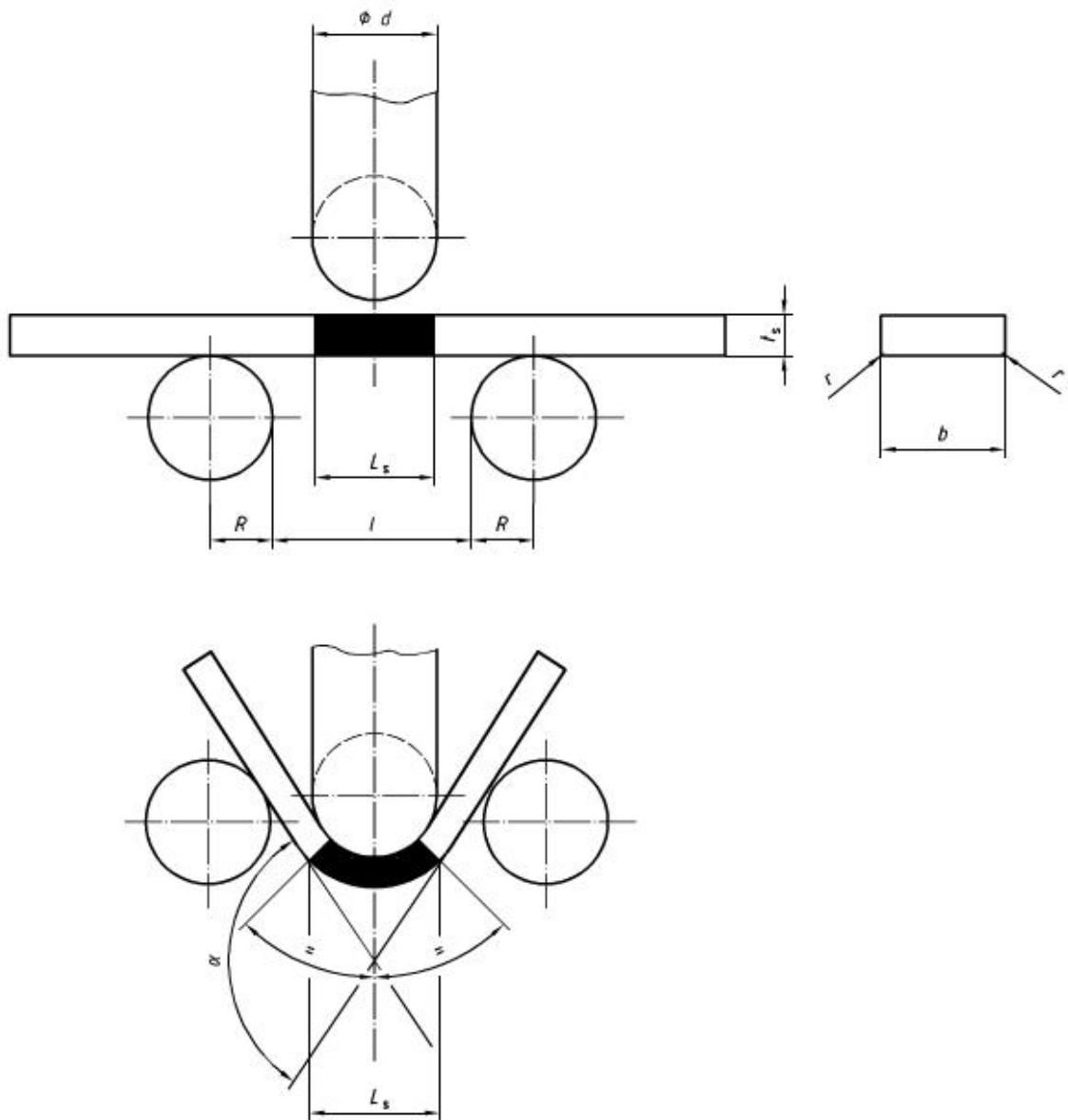
**Slika 70. Shema izvođenja ispitivanja zavarenog spoja na savijanje**
