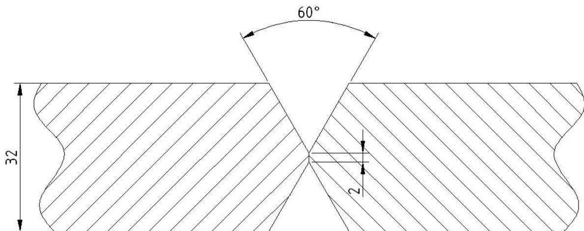
Slika 37. Priprema spoja za TIP-TIG zavarivanje
