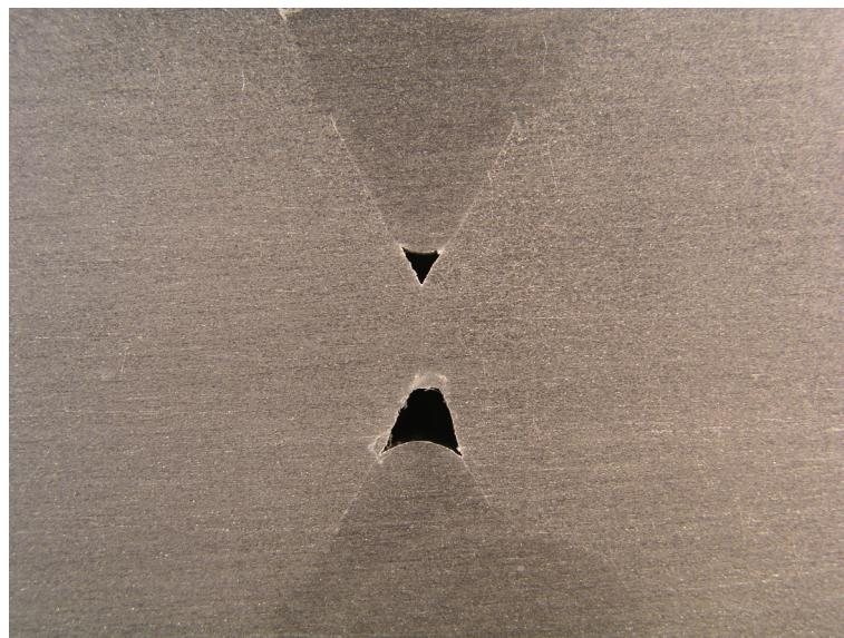
**Slika 50. Detalj 2 – greške nedovoljnog provara i naljepljivanja kod slojeva 1 i 2**
