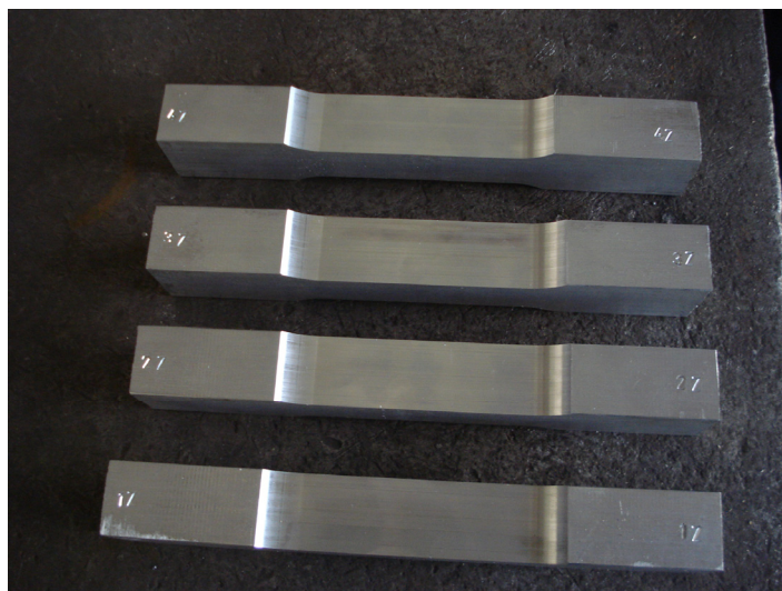
Slika 61. Označene epruvete za statičko vlačni pokus
