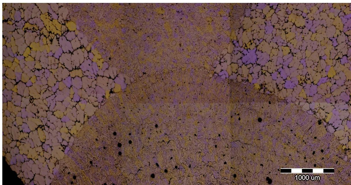
**Slika 56. Snimka mikrostrukture korijena zavara izvedenog MIG postupkom aluminijске legure EN AW 5083 u lijevanom stanju ( mjesta ispitivanja A+B )**
