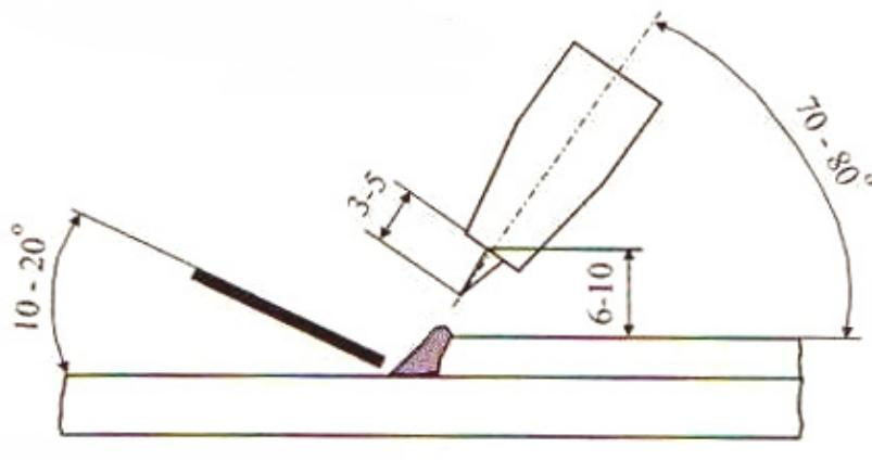
**Slika 15. Položaj pištolja i žice kod ručnog TIG zavarivanja [2]**
