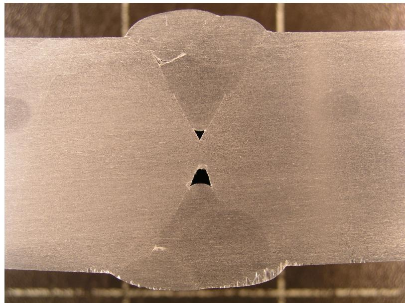
**Slika 45.** Uzorak za metalografsko ispitivanje dobiven TIP-TIG zavarivanjem
