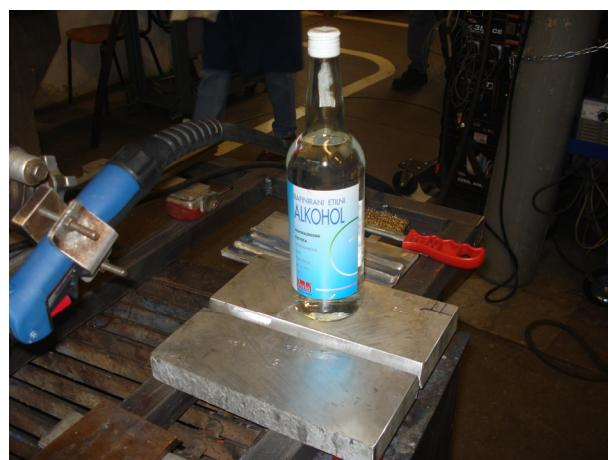
**Slika 24. Čišćenje ploča za zavarivanje**
