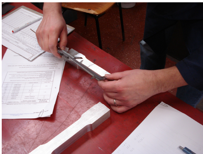
Slika 64. Mjerenje konačne duljine između dvije mjerne točke ( nakon kidanja )
