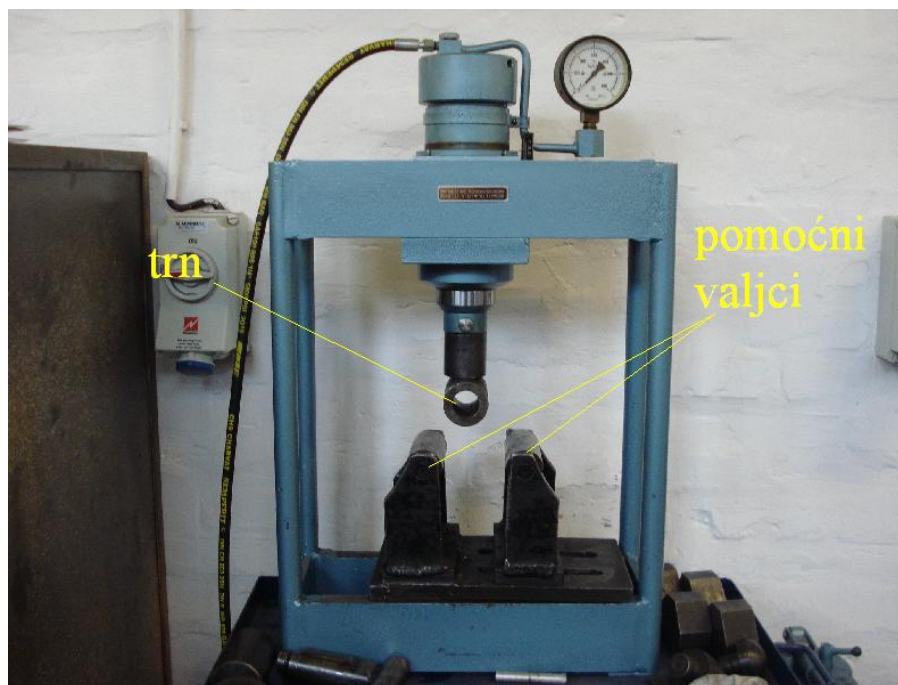
Slika 71. Naprava za ispitivanje zavarenih spojeva na savijanje
