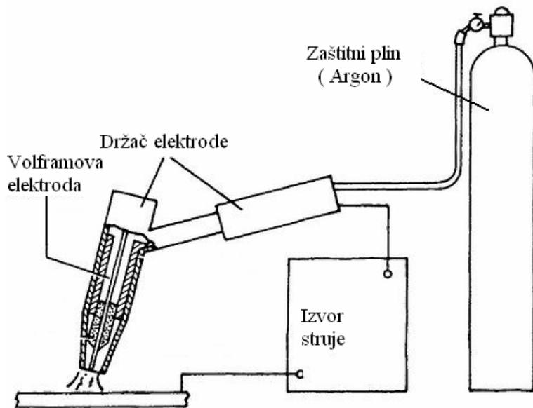
Slika 13. Shematski prikaz uređaja za TIG zavarivanje [13]
