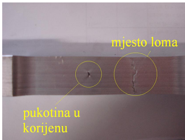
Slika 66. Epruveta 1Z nakon kidanja
