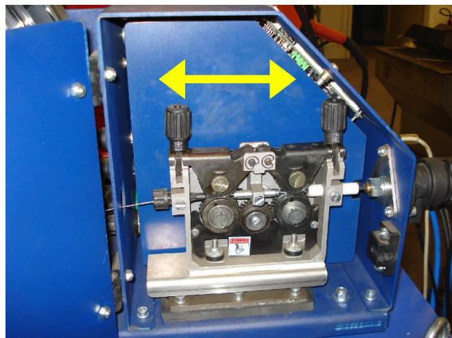
Slika 17. Princip dinamičkog dodavanja žice preko pogonskih valjčića [14]
