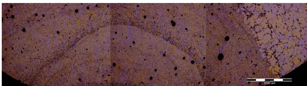
**Slika 58. Snimka mikrostrukture korijena zavara izvedenog MIG postupkom aluminijске legure EN AW 5083 u lijevanom stanju ( mjesta ispitivanja 2b-1, 2b-2, 2b-3 )**
