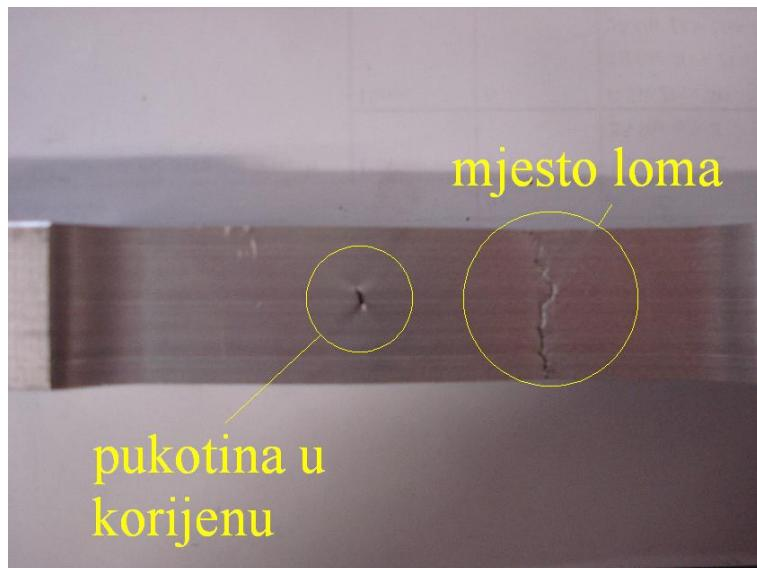
**Slika 66. Epruveta 1Z nakon kidanja**
