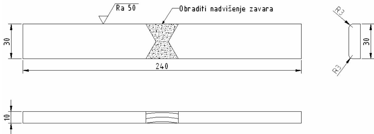
**Slika 43.** Skica epruvete za ispitivanje sučeonih zavarenih spojeva savijanjem
