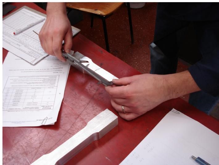
**Slika 64. Mjerjenje konačne duljine između dvije mjerne točke ( nakon kidanja )**
