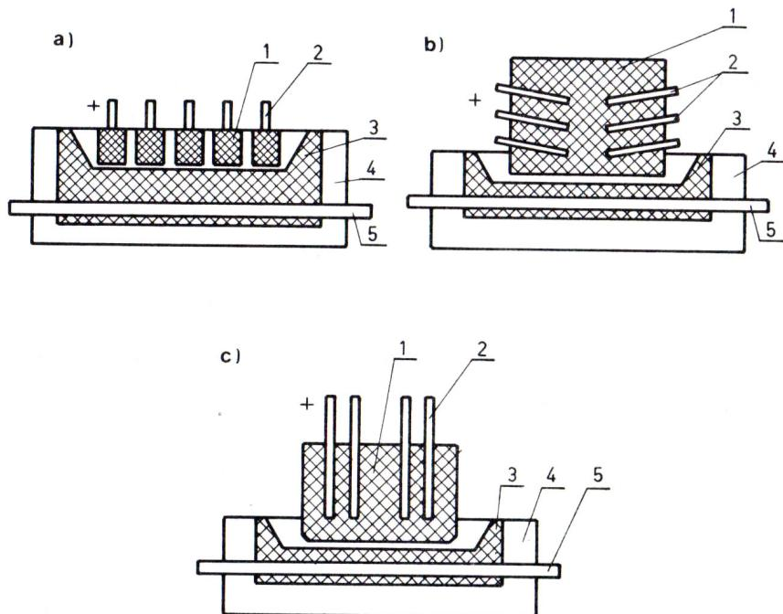
**Slika 1. Osnovni tipovi elektrolitskih čelija [3]**
