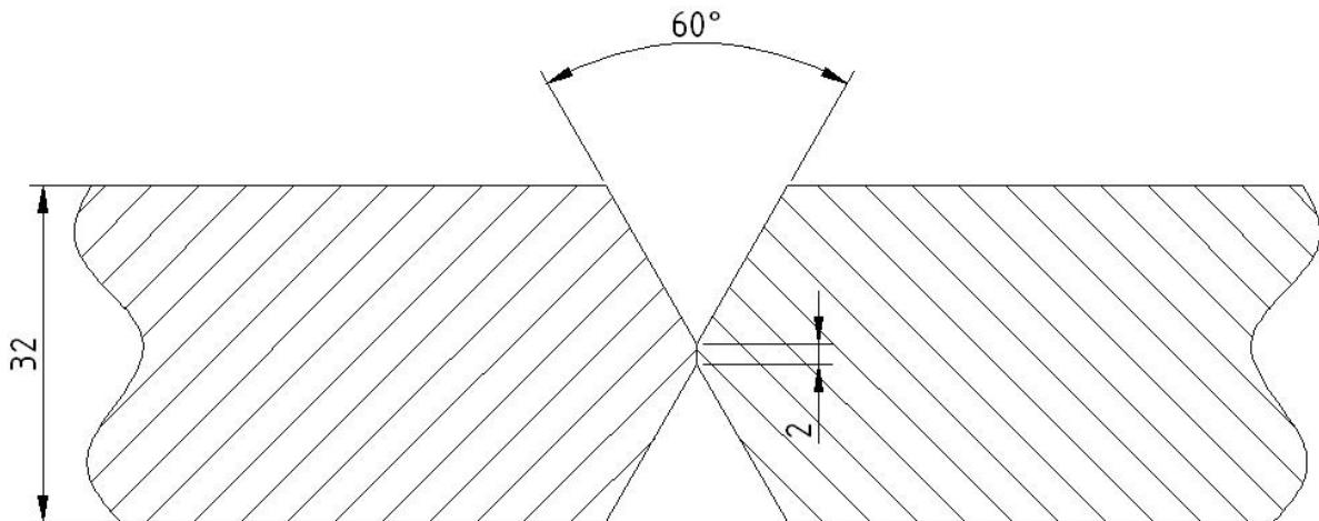
**Slika 31. Priprema spoja za MIG zavarivanje**
