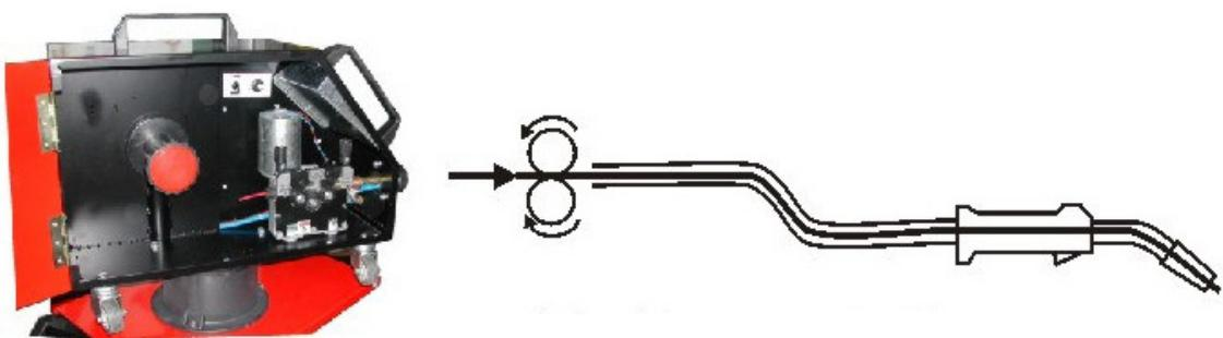
Slika 7. Shematski prikaz „push“ sustava za dodavanje žice [10]
