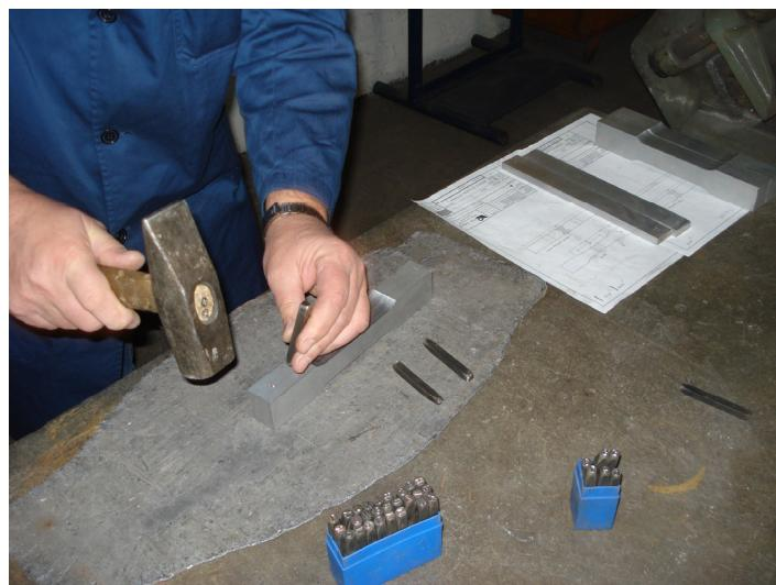
Slika 60. Označavanje epruveta za statički vlačni pokus
