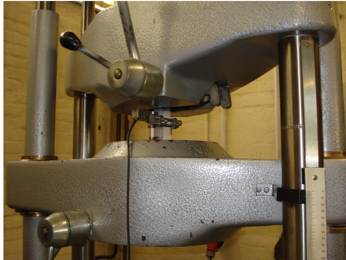
Slika 63. Epruveta u steznoj napravi kidalice s namještenim ekstenzimetrom
