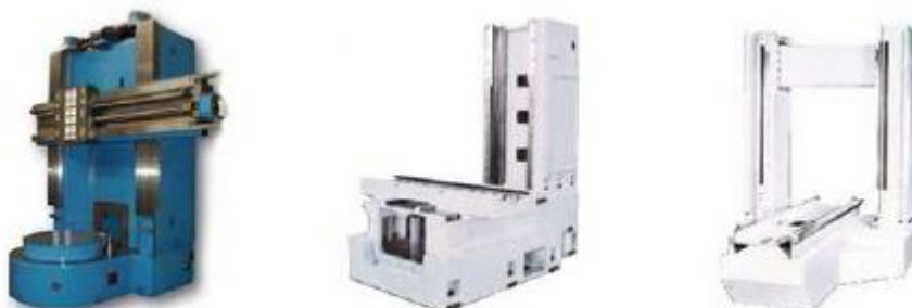
Slika 2. Noseći sustav alatnog stroja [2]
