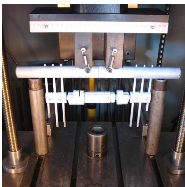
Slika 28. Model nove konstrukcije fiksatora opterećen na savijanje
