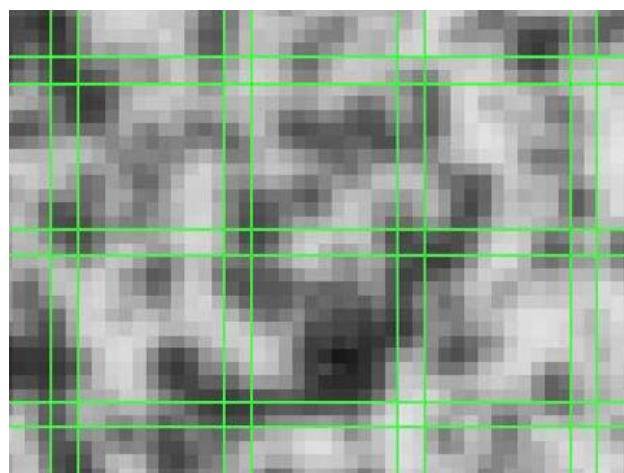
Slika 13. Faseta veličine  $15 \times 15$  s dva preklapajuća piksela
