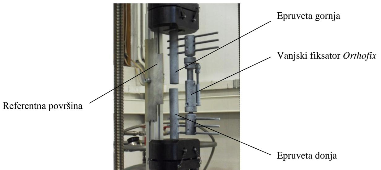
Slika 24. Fiksator u čeljustima staticke kidalice
