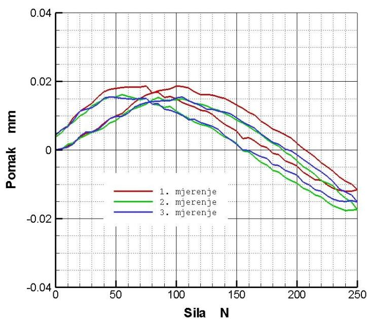
Slika 52. Pomaci u smjeru osi  $x$  na modelima kontrolne skupine s ulomcima u kontaktuTablica 8. Maksimalni pomaci u smjeru osi  $x$  na modelima s ulomcima u kontaktu
