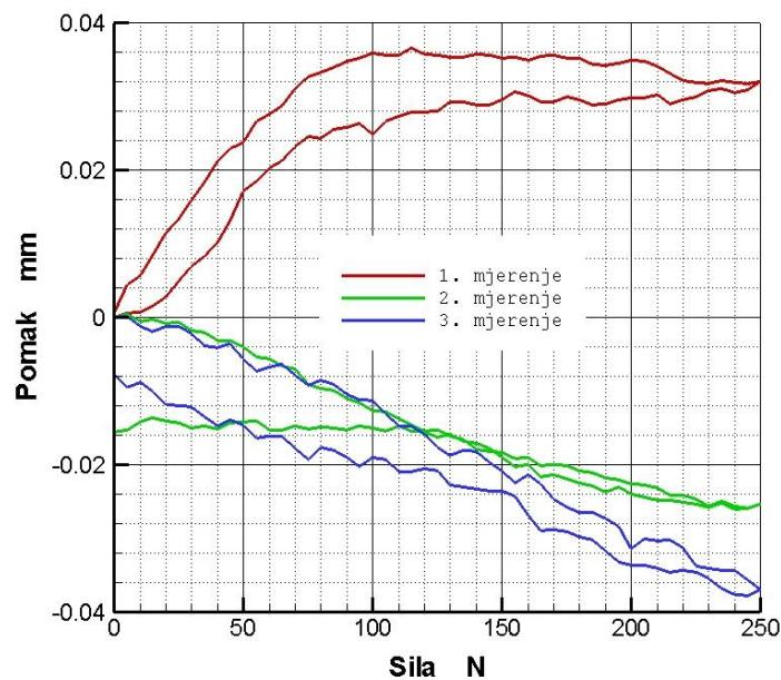
Slika 51. Pomaci u smjeru osi  $x$  na modelima ispitne skupine s ulomcima u kontaktu
