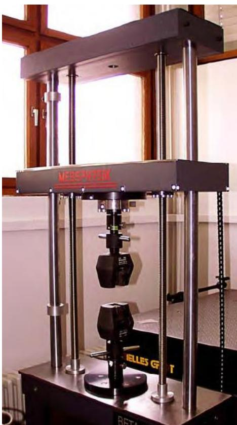
Slika 11. Statička kidalica Messphysik Beta 50-5
