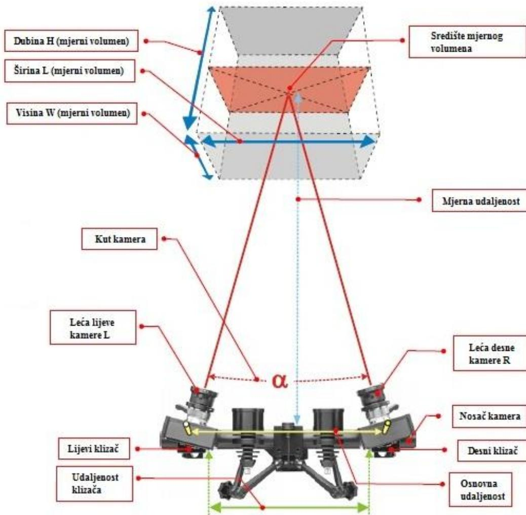
Slika 18. Parametri kalibracije sustava Aramis
