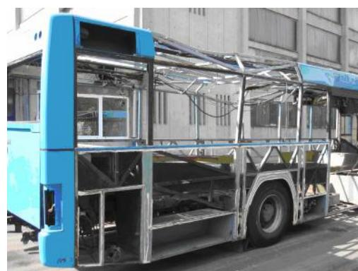
Slika 6.2. Prikaz oštećenja s desne strane
