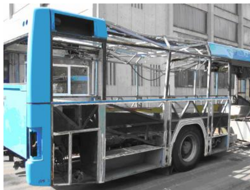
Slika 6.2. Prikaz oštećenja s desne strane
