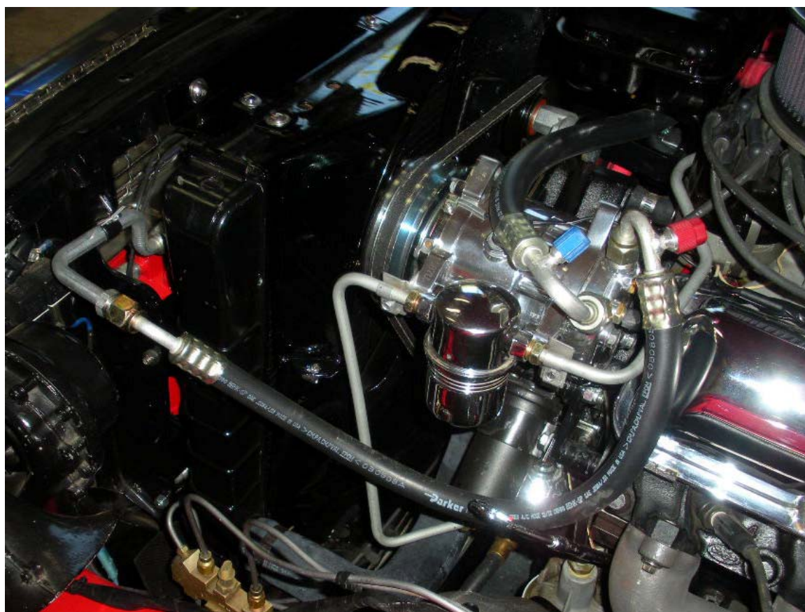
Slika 27. Prikaz spajanja komponenata rashladnog uređaja sa crijevima (preko spojnice)
