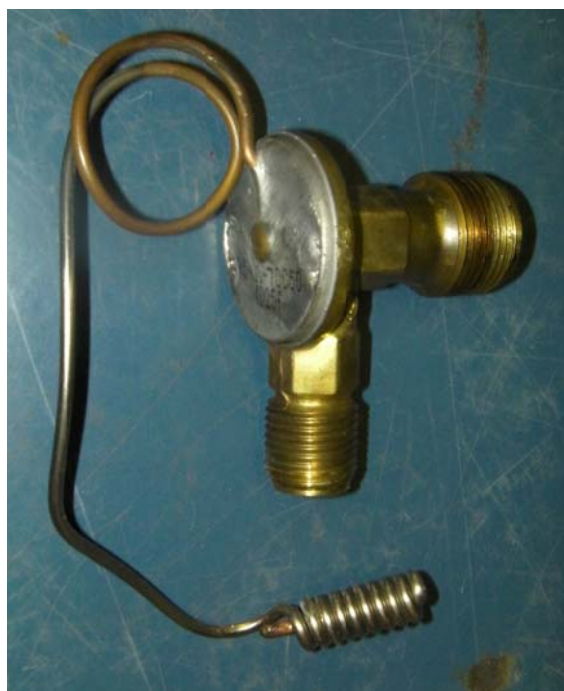
Slika 16. Termoekspanzijski ventil s vanjskim izjednačavanjem tlaka (presjek i fotografija)
