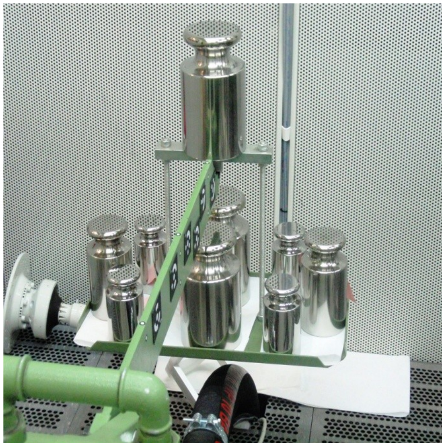
Slika 6.8. Postupak umjeravanja momenta utezima
