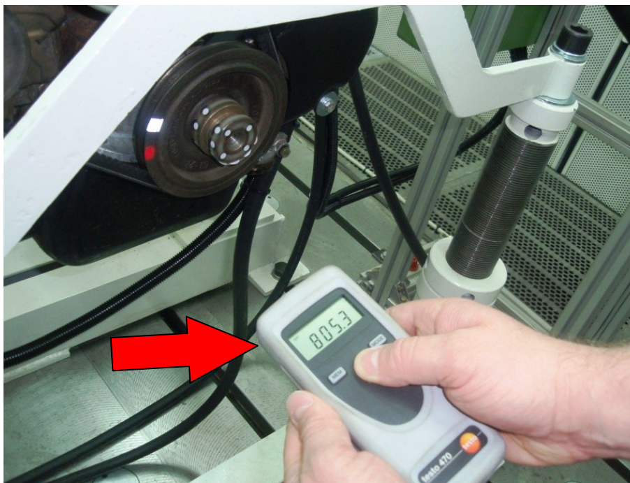
Slika 5.13. Optičko mjerenje brzine vrtnje uređajem testo 470
