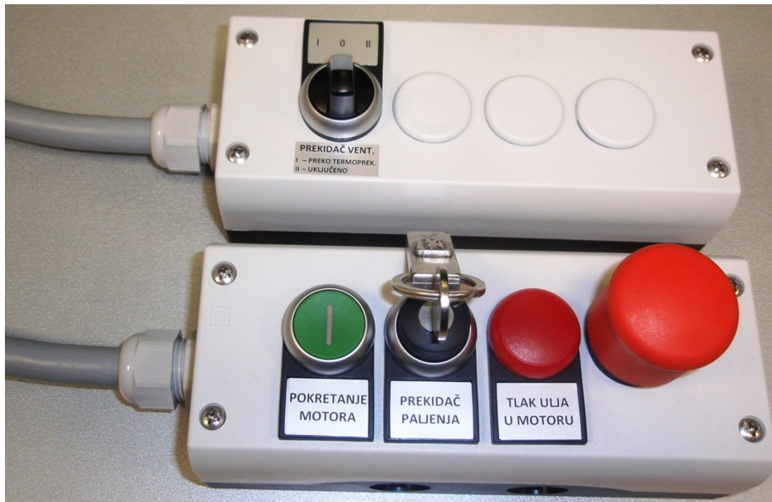
Slika 5.6. Daljinsko upravljanje radom ispitnog motora
