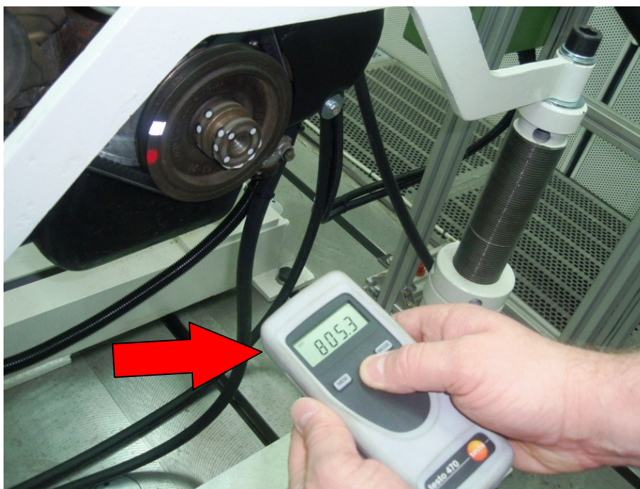
Slika 5.13. Optičko mjerenje brzine vrtnje uređajem testo 470
