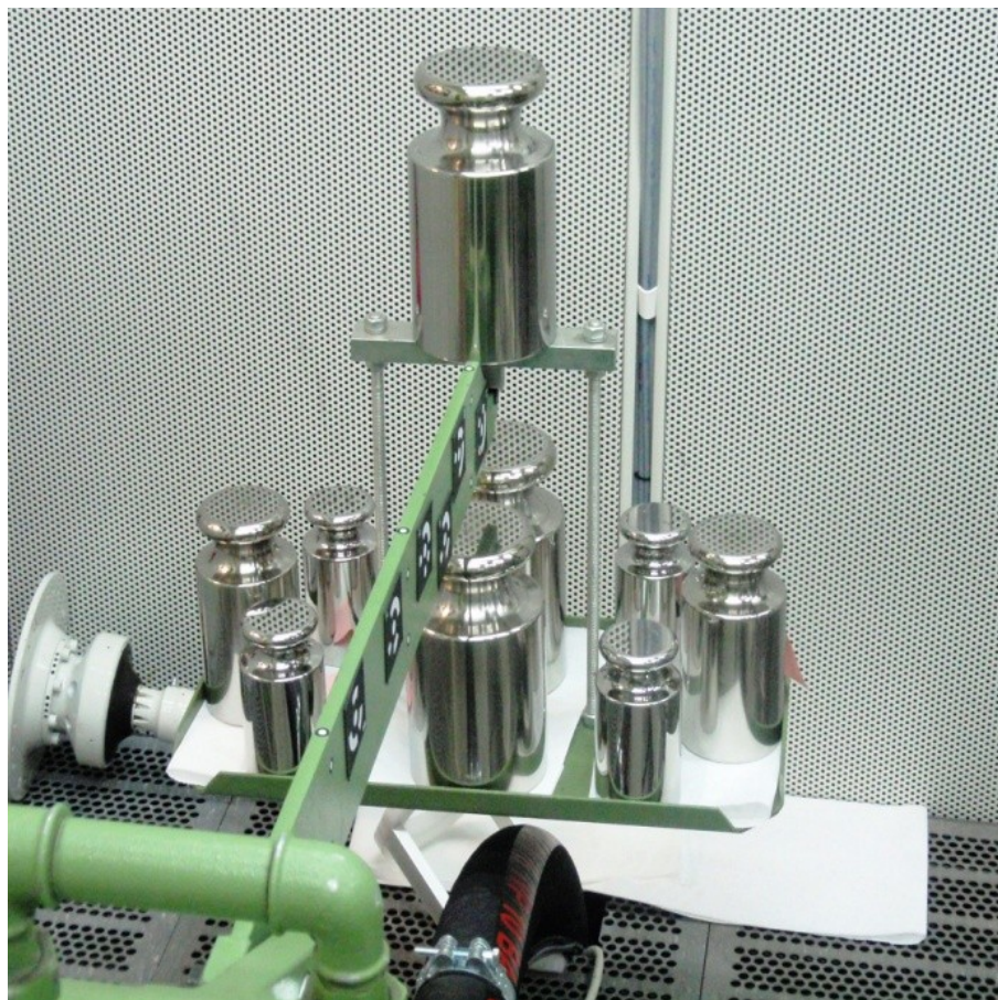
Slika 6.8. Postupak umjeravanja momenta utezima
