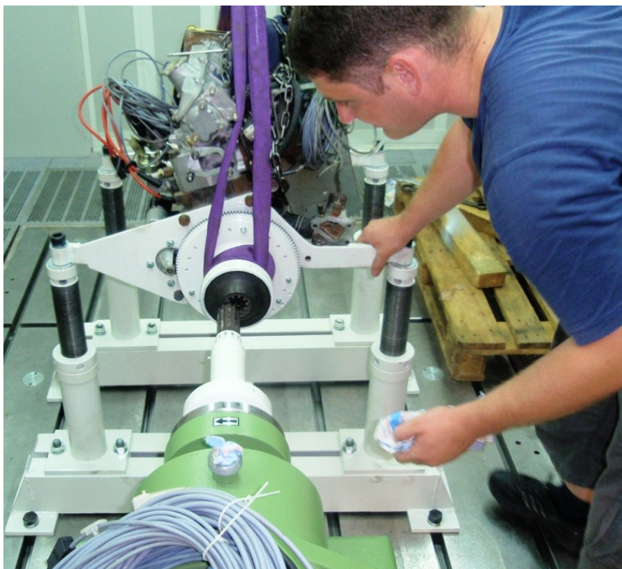
Slika 4.4. Montaža nosača motora i centriranje ispitnog motora
