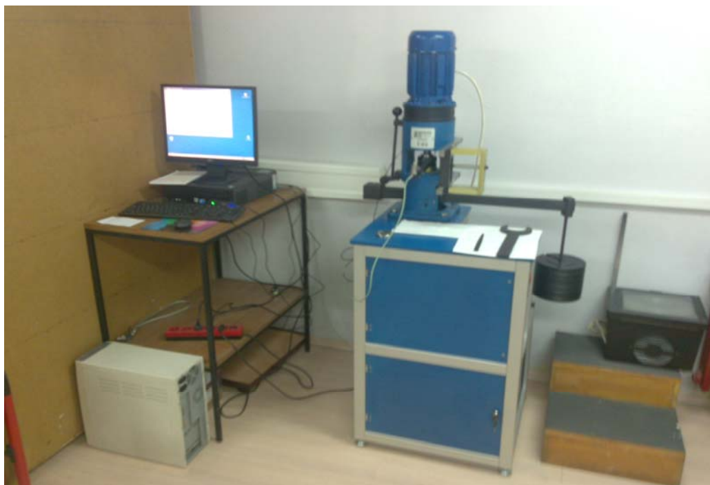
Slika 27. T - 03 Uređaj za ispitivanje metodom “4 kuglice” (“FOUR BALL”)
