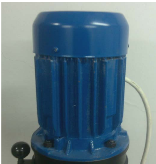
Slika 33. Asinkroni motor na uređaju T – 03
