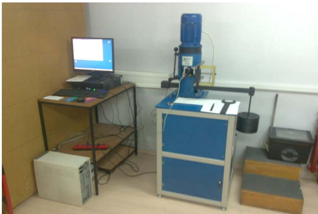
Slika 27. T - 03 Uredaj za ispitivanje metodom “4 kuglice” (“FOUR BALL”)
