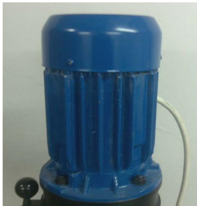
Slika 33. Asinkroni motor na uređaju T – 03
