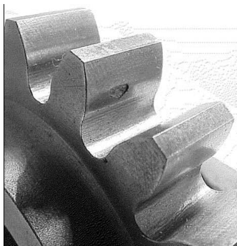
Slika 23. Slika prikazuje "flake pitting" oštećenje na zubu upčanika [7]
