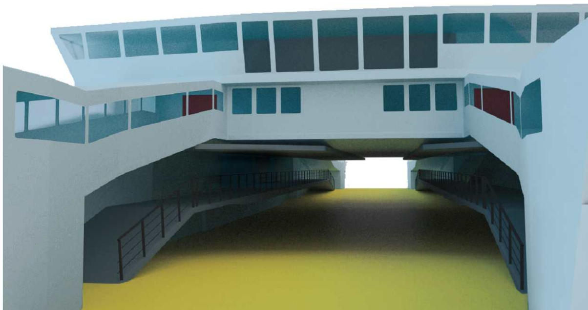
Slika 15: Prostorni prikaz garaže (dignute pomične palubice)
